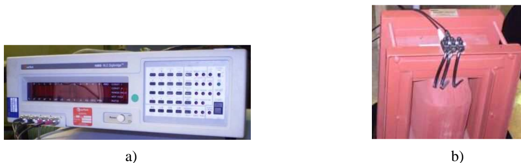
Figura 3.4 Ponte RLC QuadTech e transformador de corrente
