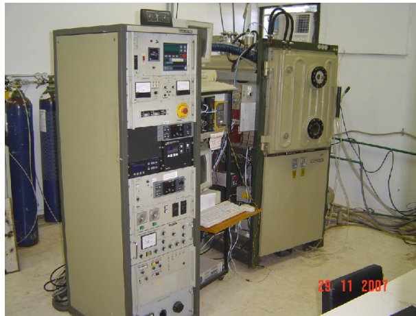
Figura 3.3: Magnetron sputtering do LMMM. A torre da esquerda abriga os controladores de vácuo, fluxo de gás e fontes, enquanto a torre da direita é a câmara de vácuo onde as amostras são depositadas.
