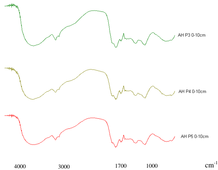
Figura 11 - Espectros de transmitância no infravermelho de ácidos húmicos purificados de amostras de solos antárticos.
