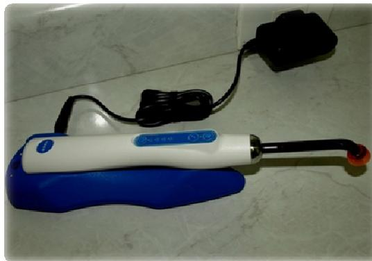
**Figura 1.** Aparelho LED utilizado na fotoativação dos espécimes (Celalux<sup>®</sup>, Voco, Alemanha).
