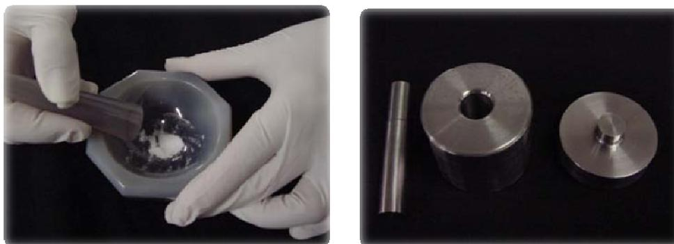
**Figuras 9 e 10.** Trituração do espécime em grau e pistilo de ágata e pastilhador metálico.
