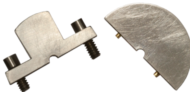
FIGURA 10. Matriz metálica bipartida em aço inoxidável, medindo 8 mm de altura e 4 mm de diâmetro interno.
