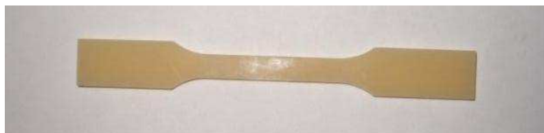
FIGURA 20 – CORPO DE PROVA APÓS REMOÇÃO DAS REBARBAS
