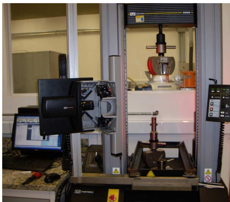
FIGURA 24 - MÁQUINA DE ENSAIO MECÂNICO - INSTRON 5569
