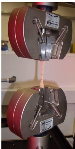
FIGURA 22 – FIXAÇÃO DO CORPO DE PROVA NAS PINÇAS
