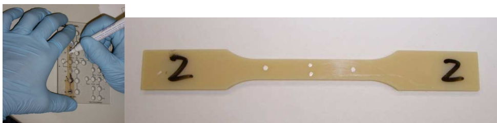
Figura 21 – MARCAÇÃO DOS QUATRO PONTOS COM GABARITO
