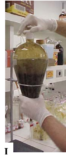
FIGURA 14 -Extração da própolis WSDP: A- Própolis bruta; B e C - Extração em álcool etílico; D- Concentração em banho- Maria; E, F, G, H, I, J e L – Extração em éter de petróleo
