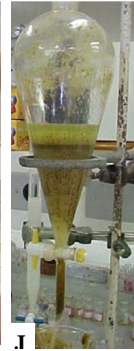
FIGURA 14 -Extração da própolis WSDP: A- Própolis bruta; B e C - Extração em álcool etílico; D- Concentração em banho- Maria; E, F, G, H, I, J e L – Extração em éter de petróleo
