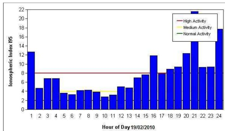
Figura 17 – Valores do índice I95 na rede GNSS-SP para o dia 19/02/2010.
