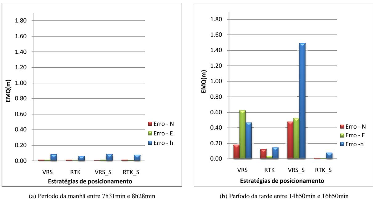
Figura 32 – EMQ obtido na estação ASSI no dia 14/01/2010 no período da manhã e da tarde
