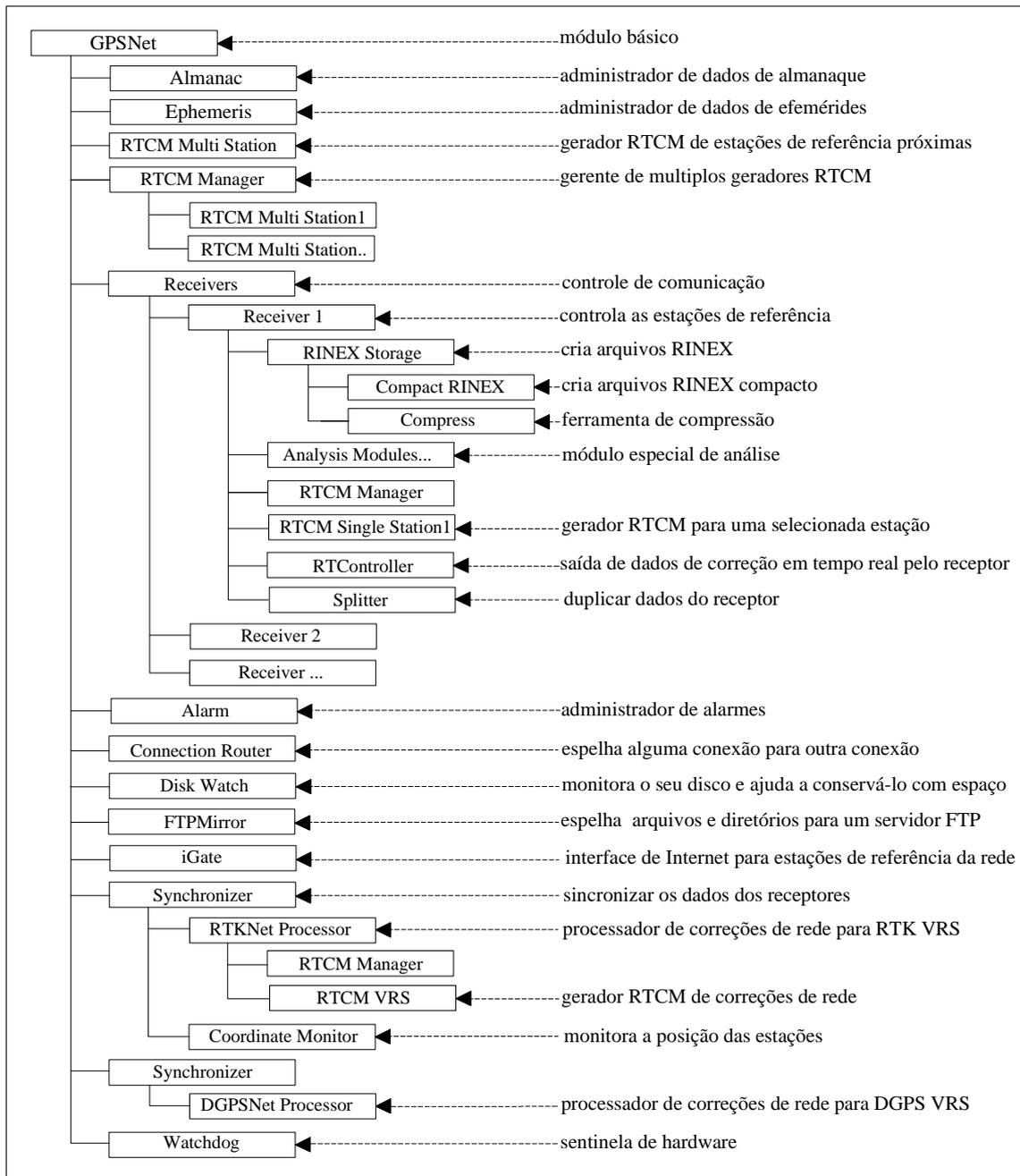
Figura 08 – Árvore com os módulos do GPSNet
