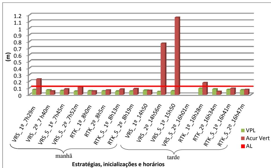
Figura C.4 – Comparação entre os resultados de VPL e os erros obtidos na estação ASSI para o dia 14/01/2010
