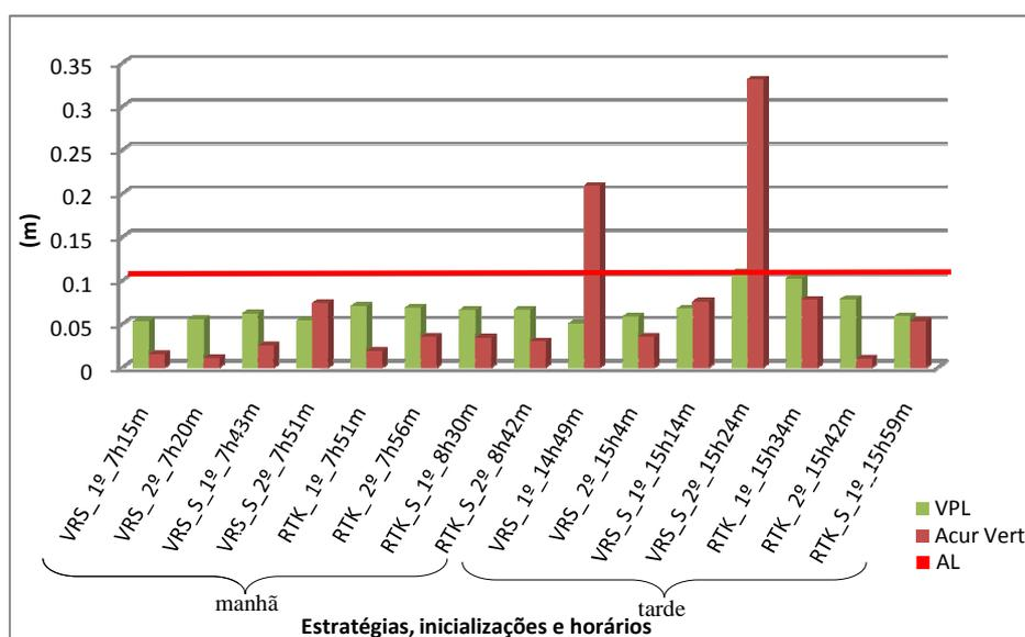
Figura C.2 – Comparação entre os resultados de VPL e os erros obtidos na estação ADAM para o dia 21/11/2009
