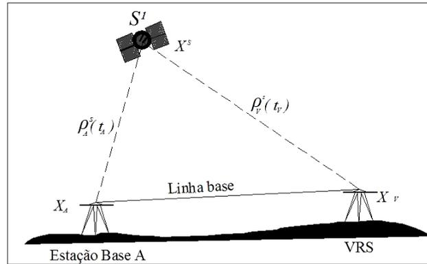
Figura 02 – Deslocamento geométrico da estação base para VRS
