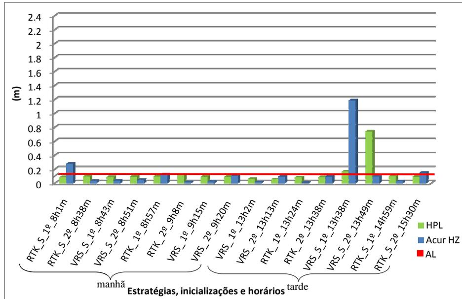
Figura C.5 – Comparação entre os resultados de HPL e os erros obtidos na estação TUPA para o dia 18/11/2009
