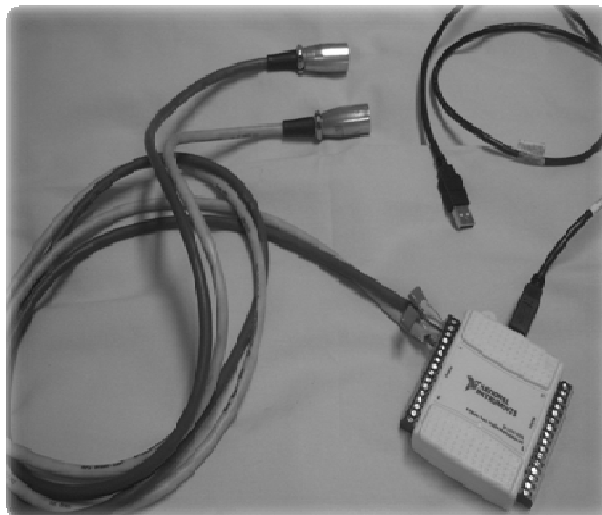
Figura 3.5 Conversor analógico-digital de 12 bits NI 6008 ( National Instruments, USA).
