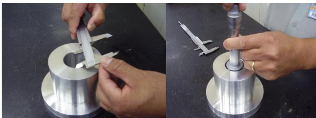
**FIGURA 4.3-** Medida de diâmetro com paquímetro e com micrômetro interno (IAE, 2010)
