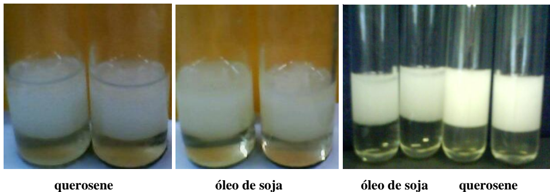
Figura 24 – Capacidade de emulsificação do biossurfactante produzido por Bacillus subtilis LAMI005 em querosene e óleo de soja.
