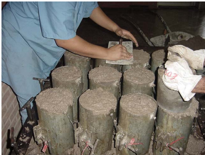
FIGURA 3.19 Corpos-de-prova Adensados em Mesa Vibratória
