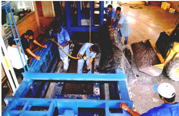
FIGURA 5.27 Compactação das Extremidades do Maciço Experimental
