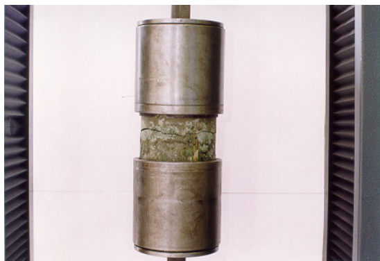
(c) Ruptura do Corpo-de-prova
