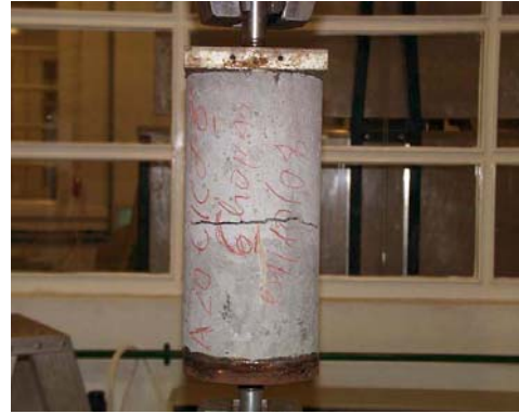
FIGURA 3.11 Ensaio para Determinação da Resistência à Tração Direta Executados por RIBEIRO, em 2002
