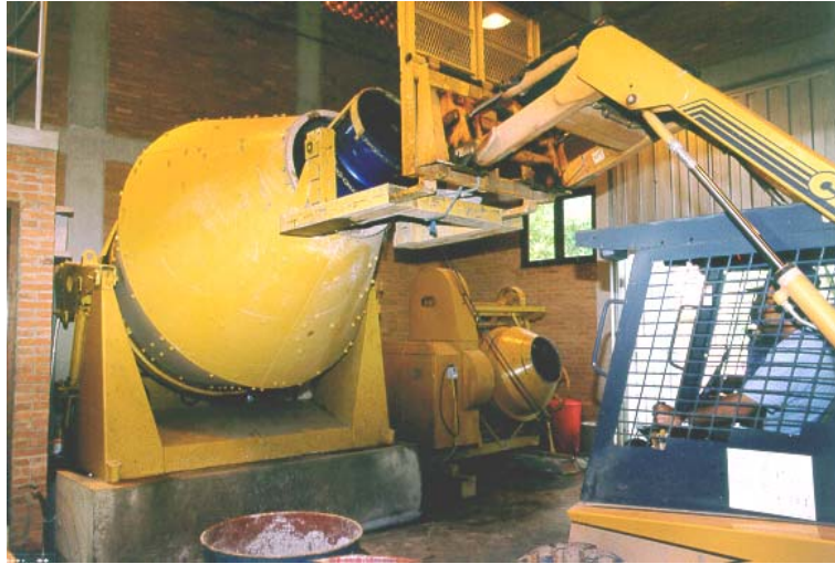
FIGURA 5.23 Sala de Dosagem e Carregamento da Betoneira
