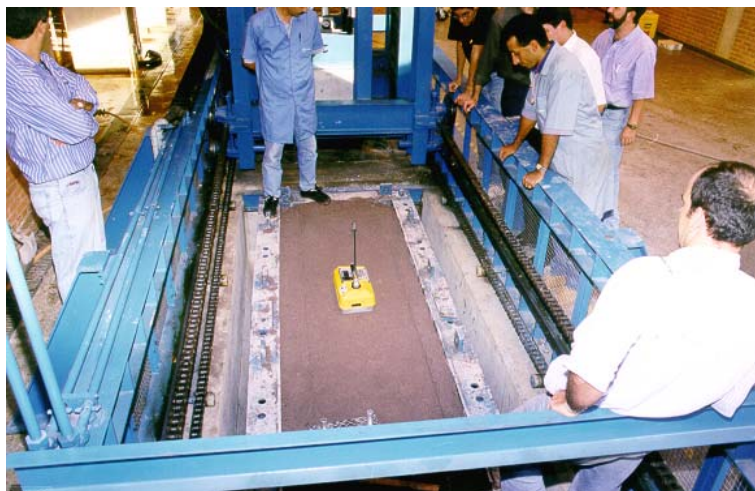
FIGURA 5.31 Medição da Massa Específica do CCR com Utilização do Densímetro Nuclear
