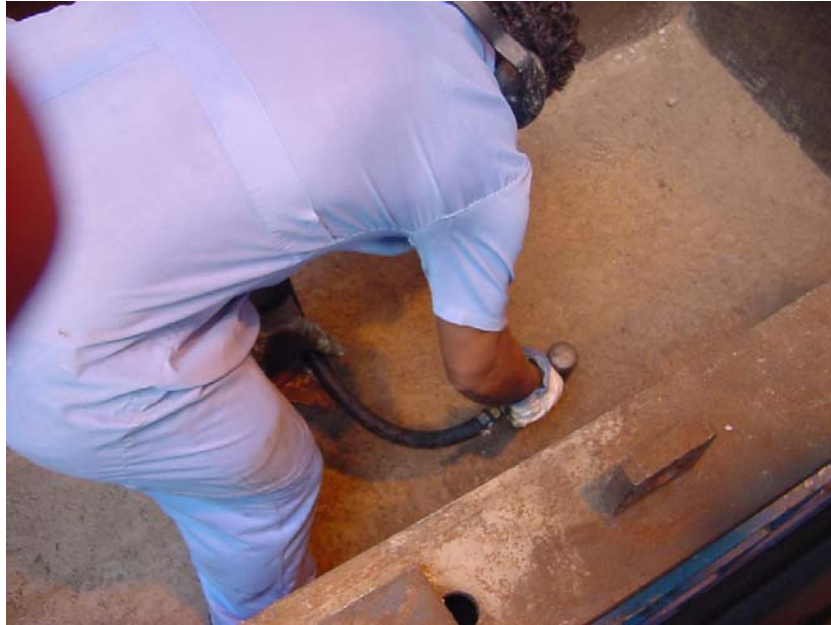
FIGURA 5.17 Apicoamento do Topo da Camada Simulando Corte com Jato de Alta Pressão
