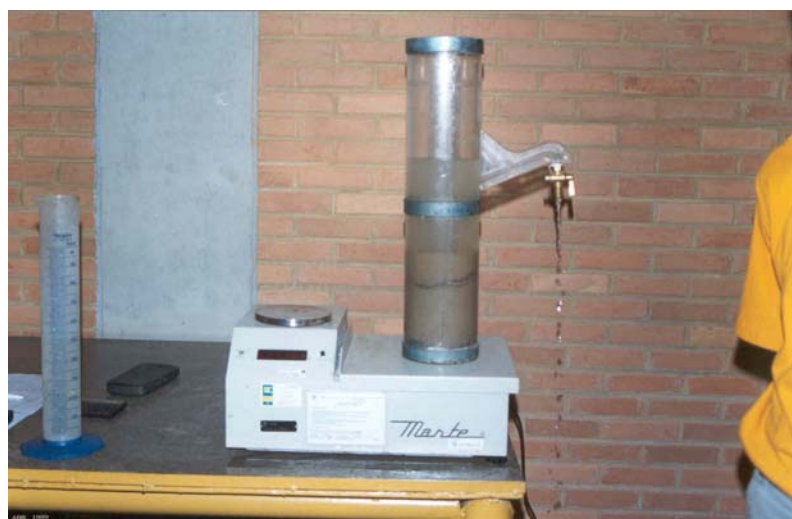
FIGURA 2.22 Dispositivo para Medida do Teor de Água (DMA)
