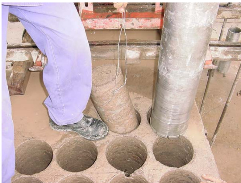
FIGURA 5.11 Retirada do Testemunho do Furo
