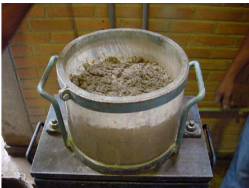
(b) Fase Intermediária com CCR Adensando
