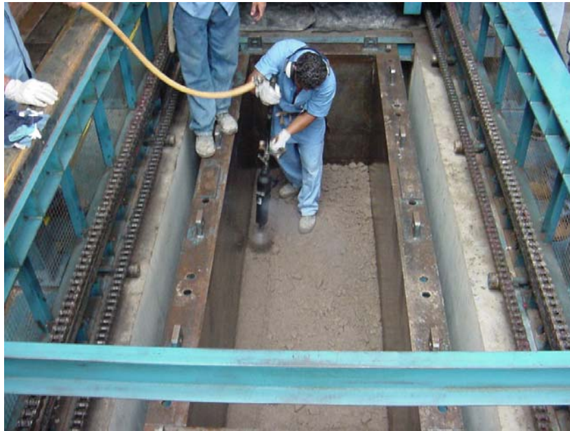
FIGURA 5.3 Compactação Manual da Lateral de Camada do Maciço Experimental em Laboratório
