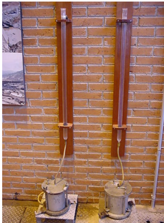
FIGURA 2.21 Ensaio de Permeabilidade do Concreto Fresco
