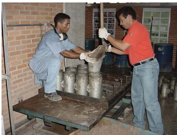
FIGURA 2.19 Moldagem e Compactação em Mesa Vibratória de Corpos-de-prova de CCR
