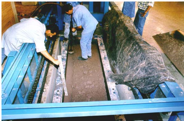
FIGURA 5.28 Medição da Altura da Camada Após Compactação das Extremidades
