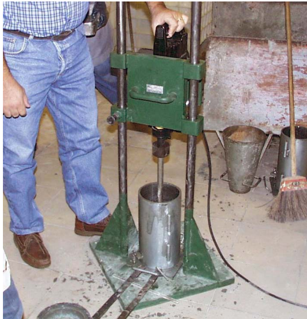
FIGURA 3.18 Adensamento de Corpo-de-prova com Martetele Tipo Kango Fonte: RIBEIRO et al., 2002
