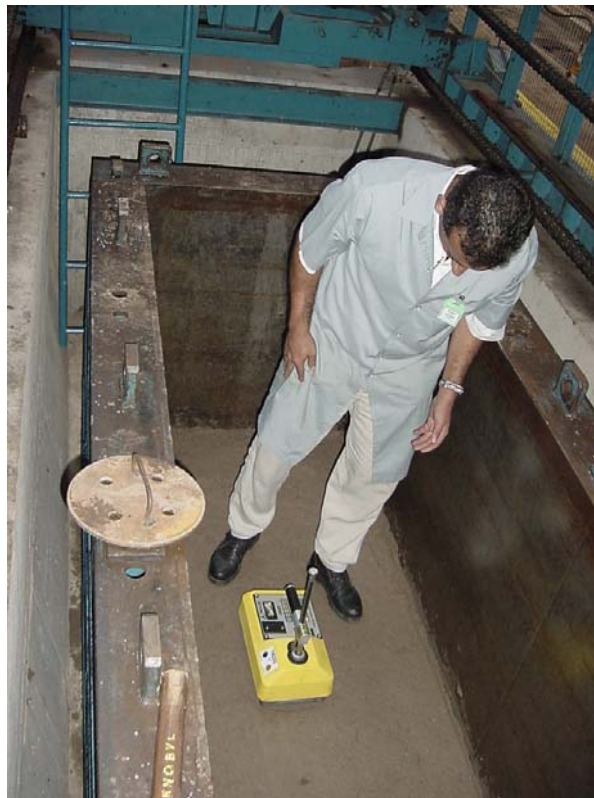
FIGURA 3.22 Utilização do Densímetro Nuclear durante a Execução de Maciço Experimental em Laboratório
