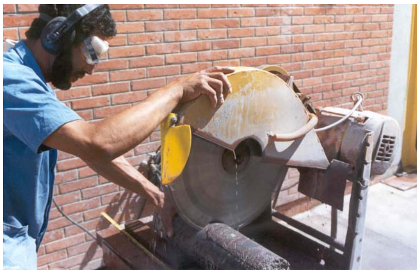
FIGURA 5.14 Usinagem de Testemunhos para Obtenção de Corpos-de-prova
