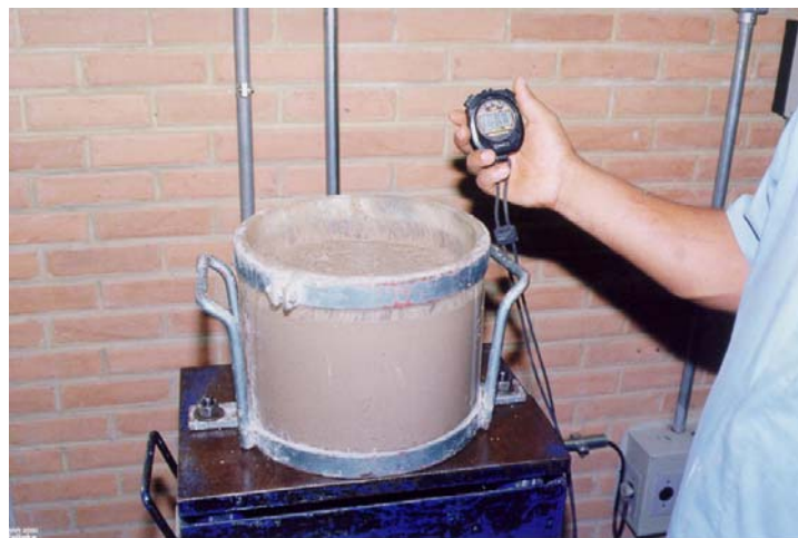
FIGURA 2.18 Aparelho Vebe Modificado
