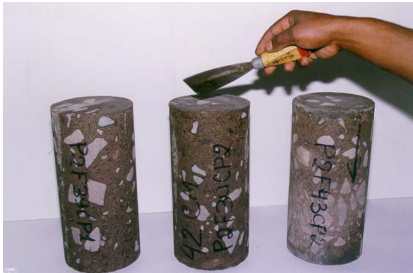
FIGURA 5.15 Aspecto dos Topos dos Corpos-de-Prova Obtidos de Testemunhos após a Usinagem
