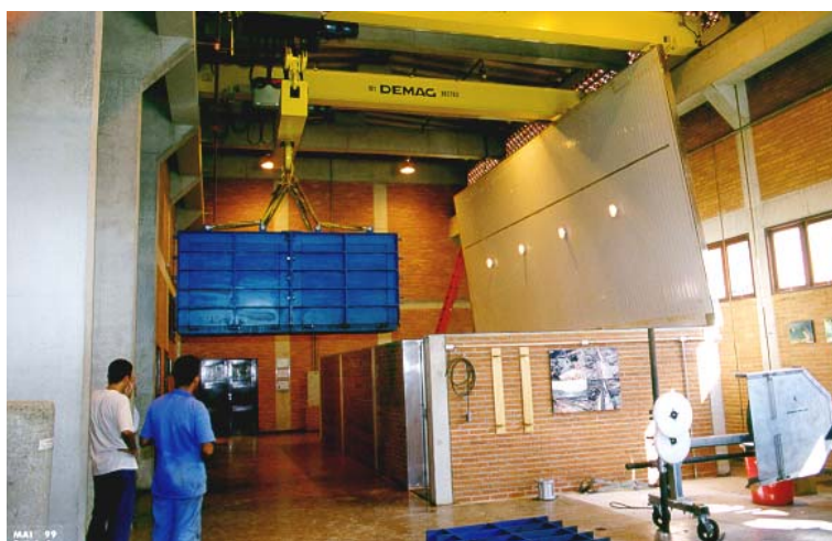
FIGURA 5.34 Colocação na Câmara Úmida
