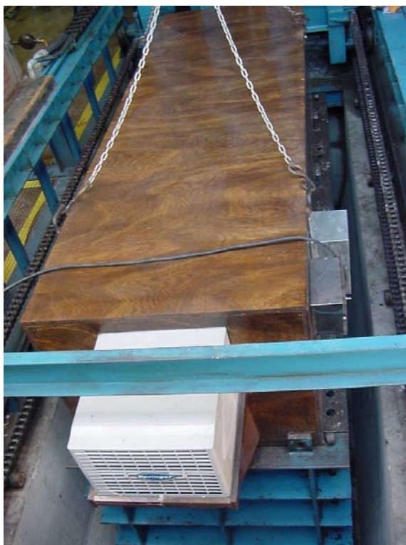
FIGURA 5.7 Aparato para Controle Ambiental Instalado
