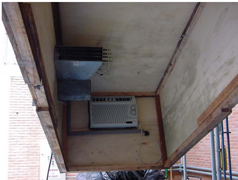
FIGURA 5.6 Equipamento Embutido no Aparato para Controle Ambiental
