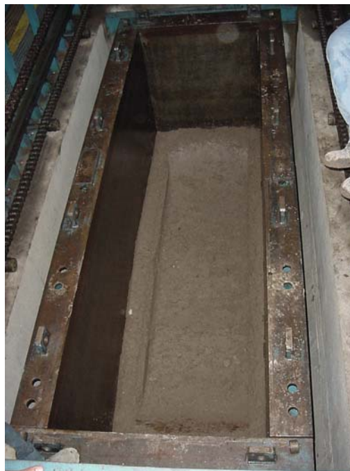
FIGURA 5.2 Topo de Camada recém Compactada em Maciço Experimental no Laboratório
