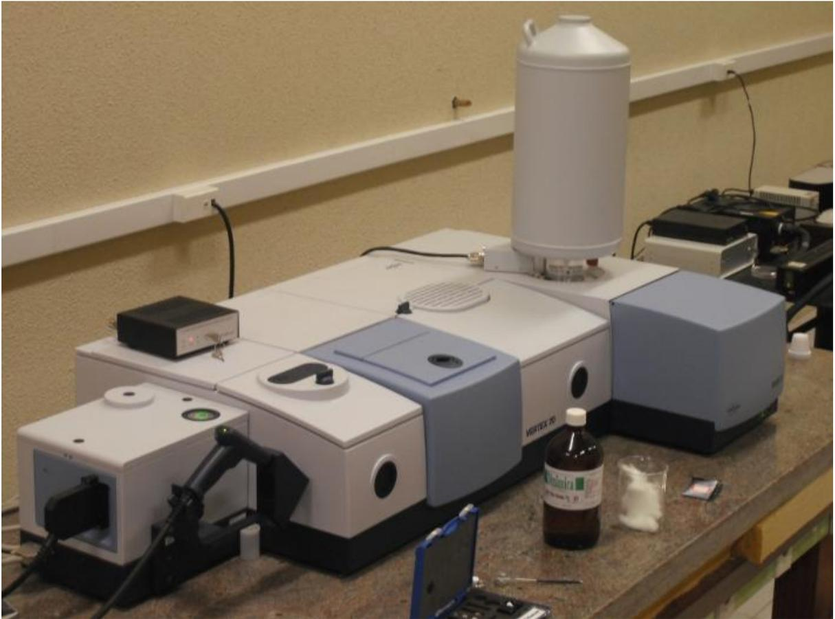
Figura 3.5 Espectrômetro Raman por transformada de Fourier.
