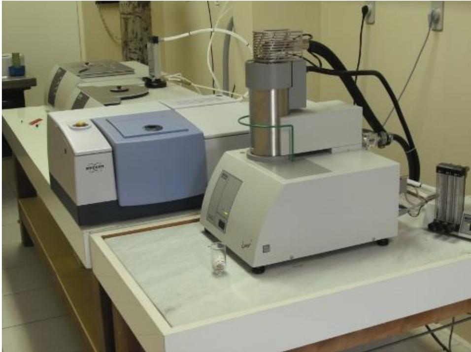
Figura 3.2 Equipamento de calorimetria diferencial de varredura (DSC).
