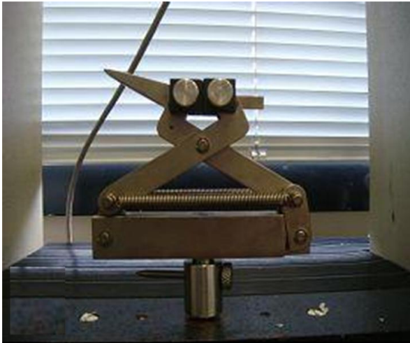
Figura 12 – a) Garra utilizada para fixar o material durante os ensaios de tração; b) músculo sóleo fixado às garras.
