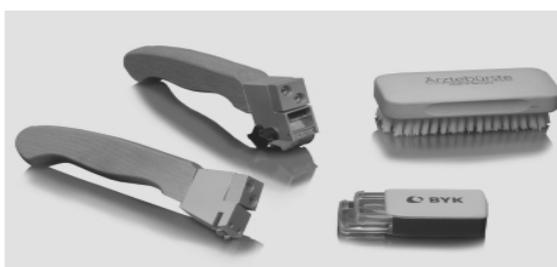
Figura 59 – Aparelho para ensaio de adesão [55]
