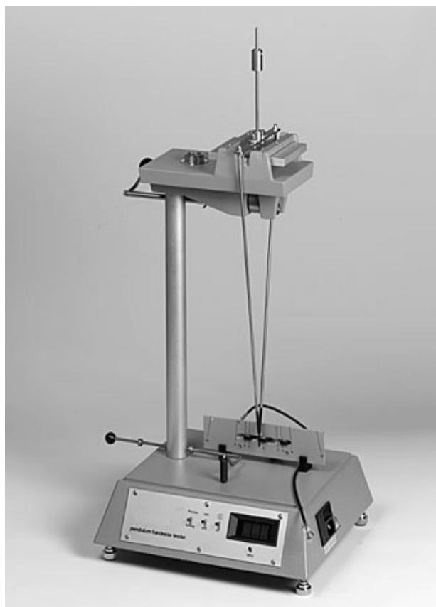
Figura 55 – Equipamento de Dureza “König”[55]
