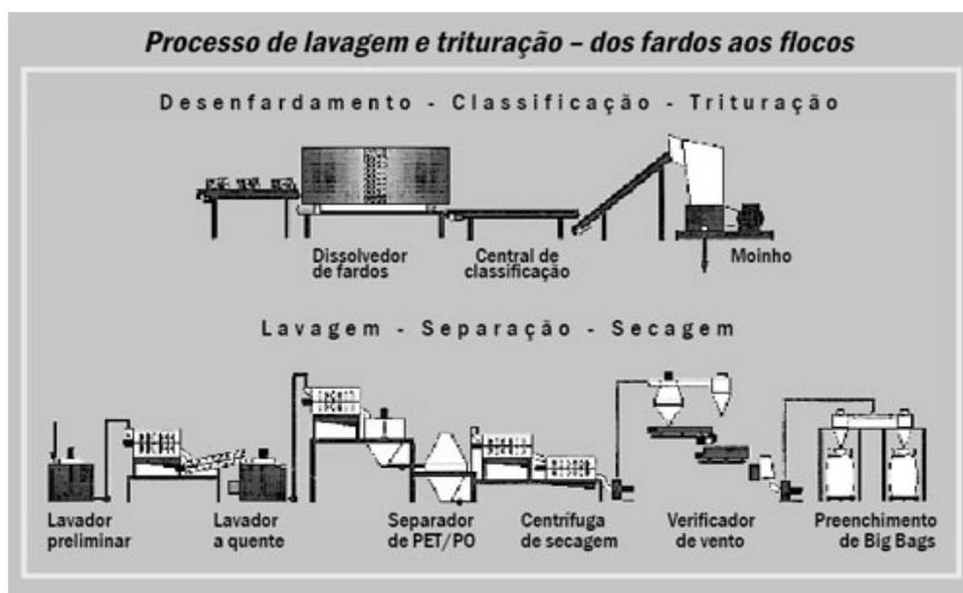
Figura 1 – Processo de reciclagem mecânica de PET [9]
