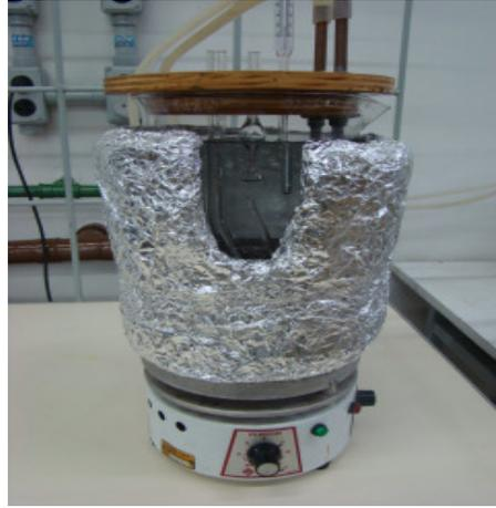
Figura 48 - Viscosímetro no banho
