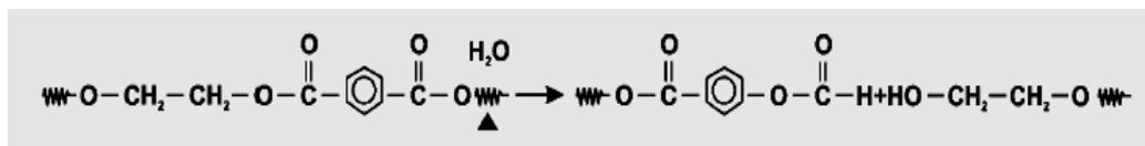
Figura 15 – Reação de degradação hidrolítica (hidrólise) das resinas PET [16]
