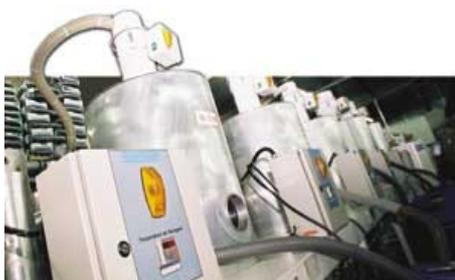
Figura 16 - Secador de resina PET [20]
