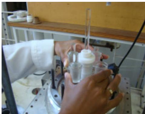
Figura 41 - Frasco “*kettle*” na cavidade multimodal
