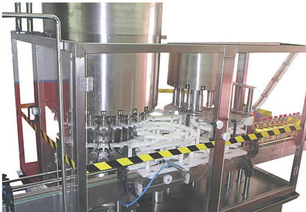
Figura 39 - Envasadora rotativa para tintas [45]
