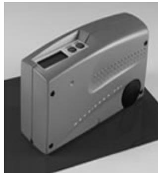
Figura 57 - Medidor de Distinção de imagem [55]
