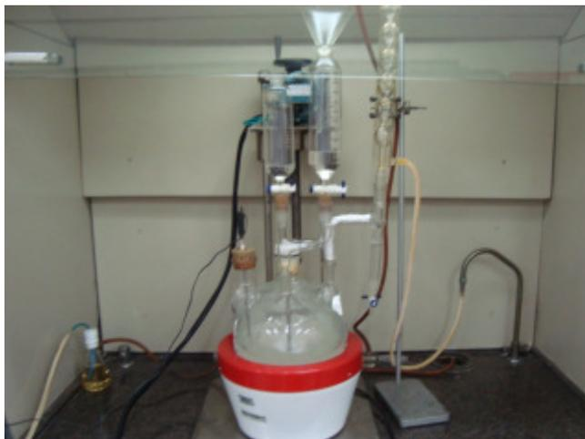
Figura 44 – Reator (balão) de Laboratório
