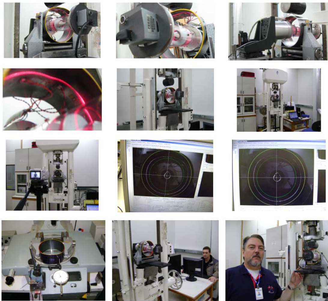
Figura 36: De cima para baixo, da esquerda para direita, CP e Sistema PEROLA usado para medir a geometria interna do CP, a máquina de tração com o indentador fixado ao carro móvel, acompanhamento fotográfico, sistema aquisitório, bancada para medição com relógio comparador e, Pedro Buschinelli e o autor [Do autor].
