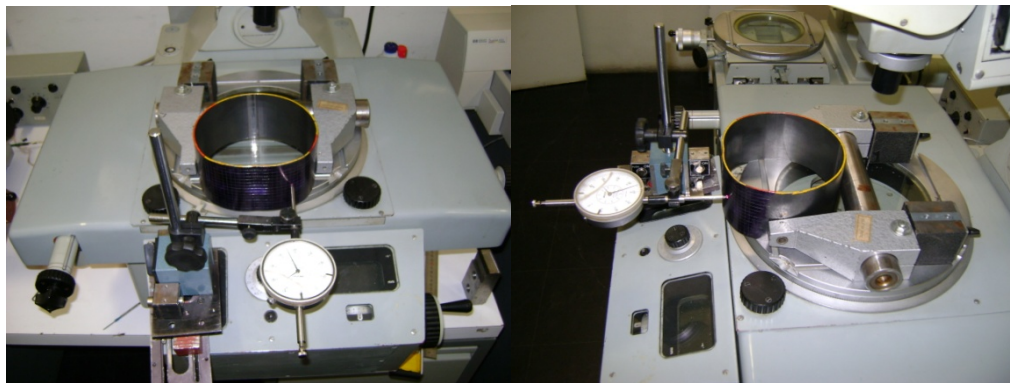
Figura 39: Medição tridimensional do CP [Do autor].
