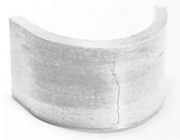
Figura 26: Falha em flexão (Dobramento) [25].
