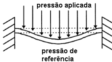
Figura 3.1: Diagrama típico do diafragma de um transdutor de pressão. Fonte: (6)
