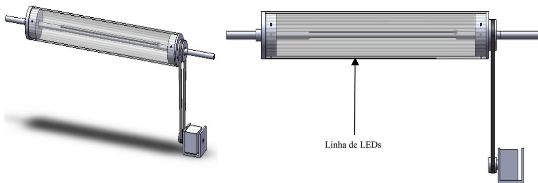
Figura 21 Duas vistas do sistema de iluminação estruturada
