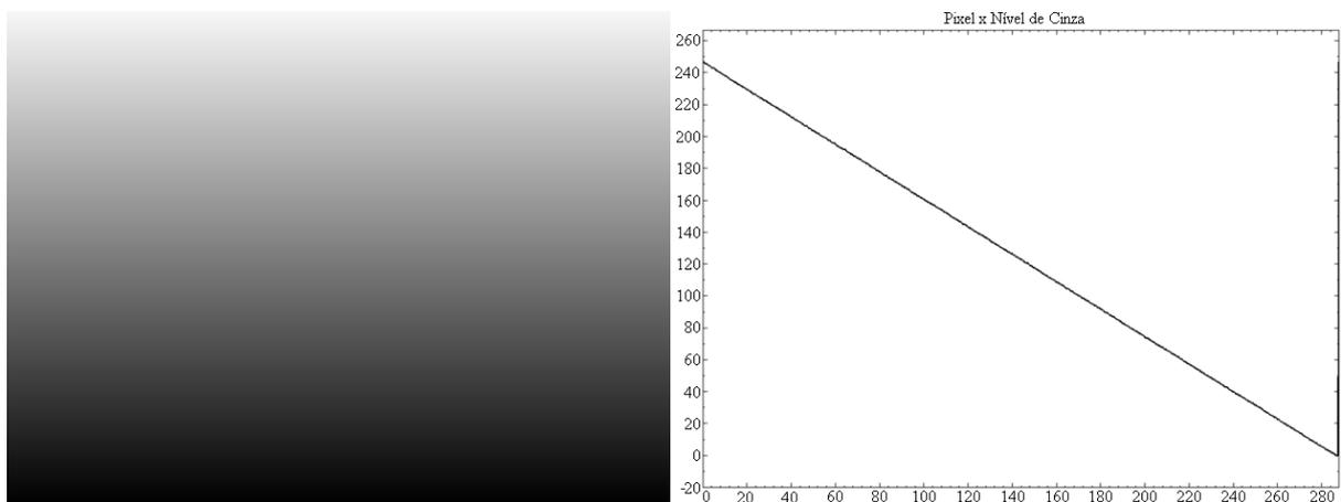
Figura 13 À esquerda, imagem do mapa de fase absoluto e à direita o gráfico da intensidade dos níveis de cinza dos pixels de uma linha paralela ao eixo y da imagem.
