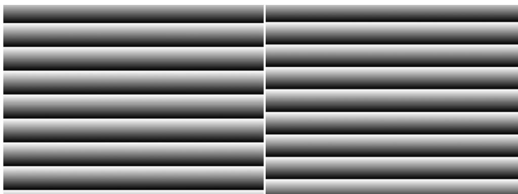
Figura 36 Mapas de fase com diferença de 0,5 comprimento de franja entre eles.
