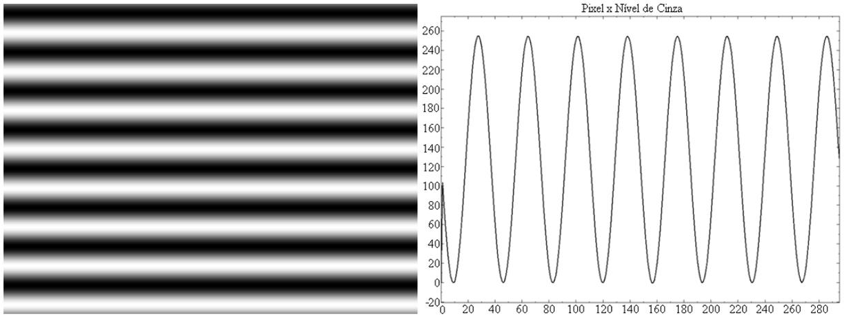
Figura 10 Padrão de projeção senoidal e o gráfico da intensidade dos níveis de cinza dos pixels de uma linha paralela ao eixo y da imagem.
