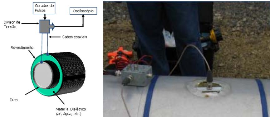
Figura 6 (a) À esquerda, esquema do sistema de medição (b) À direita, o sistema realizando uma inspeção [40].
