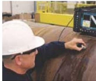
Figura 1 Inspeção de duto com transdutor "phased array" [36].
