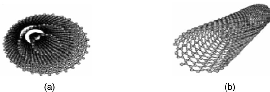
**Figura 2** – Estrutura básica de um nanotubo de paredes múltiplas (a) e um nanotubo de parede simples (b) <sup>[14]</sup>.
