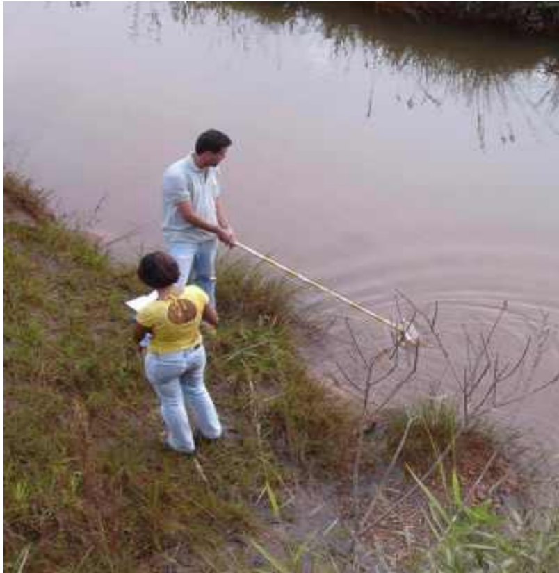
Figura 3.2 – Ribeirão dos Coqueiros localizado na entrada próximo a estrada para cidade de Fonseca (ponto 09). Coleta próxima a margem do ribeirão com amostrador adaptado.
