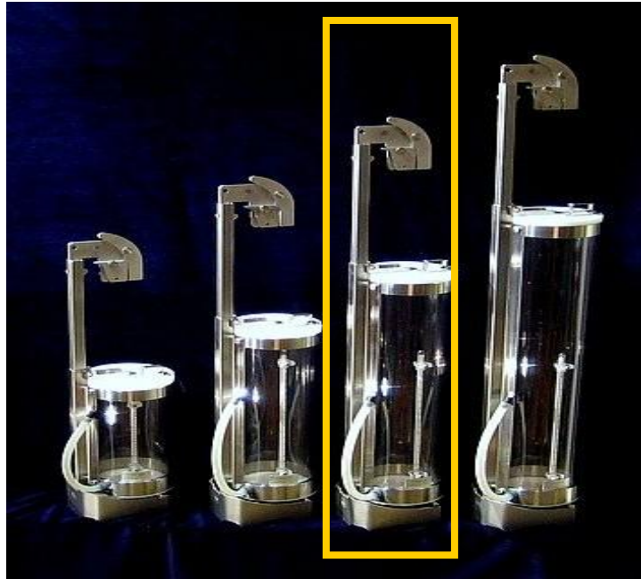
Figura 3.4 – Amostrador tipo Limnus utilizado no trabalho para coleta de água em lugares suspensos, como pontes, capacidade 2 litros e meio.
