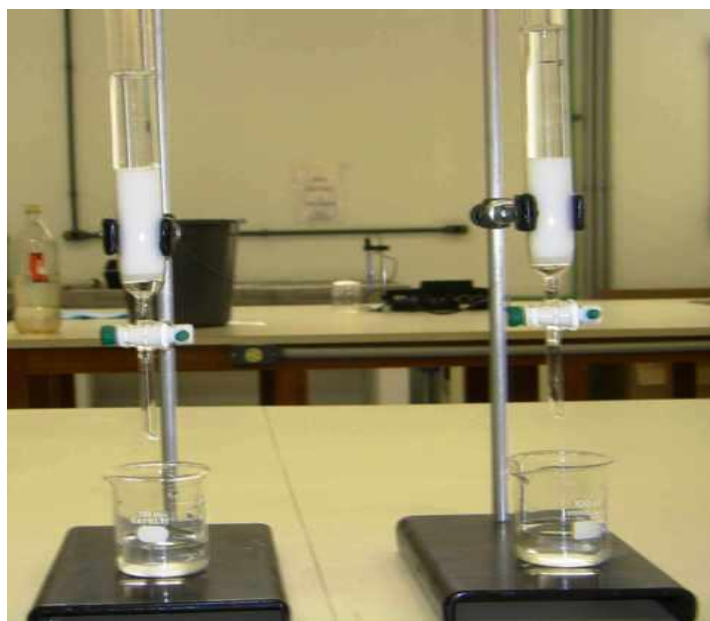
Figura 3.6 – Coluna de vidro contendo a resina XAD-8 clareada para posterior eluição da amostra e processo de extração.
