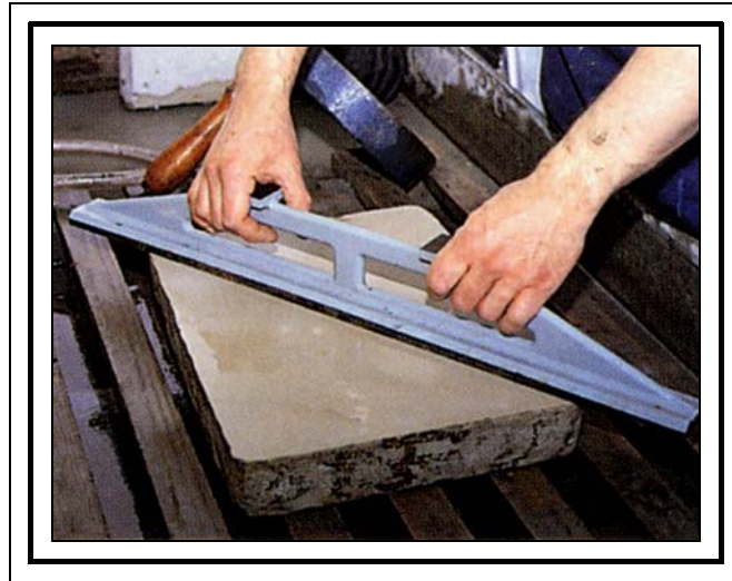
Figura 2 – Verificação da planeza da pedra.
