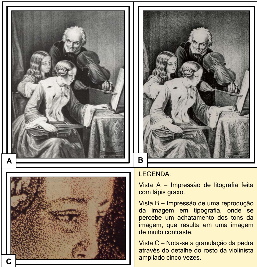
Figura 8 – Matriz litográfica obtida com a utilização de lápis graxos e desenho realizado diretamente sobre a pedra.
