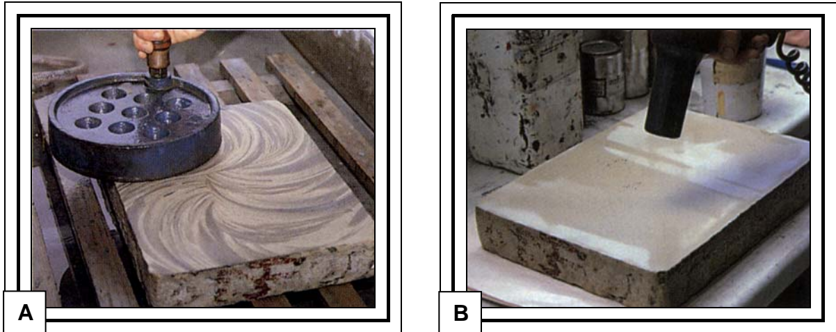
Figura 3 – Etapa de polimento da pedra (Vista A) e secagem da pedra polida (Vista B).
