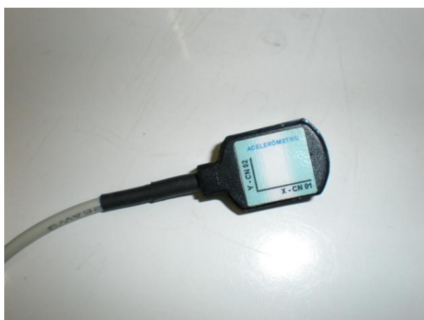
Figura 3: Acelerômetro da marca EMG System do Brasil para captação da aceleração do membro superior.
