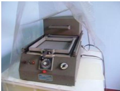
Figura 52. Thermoform
