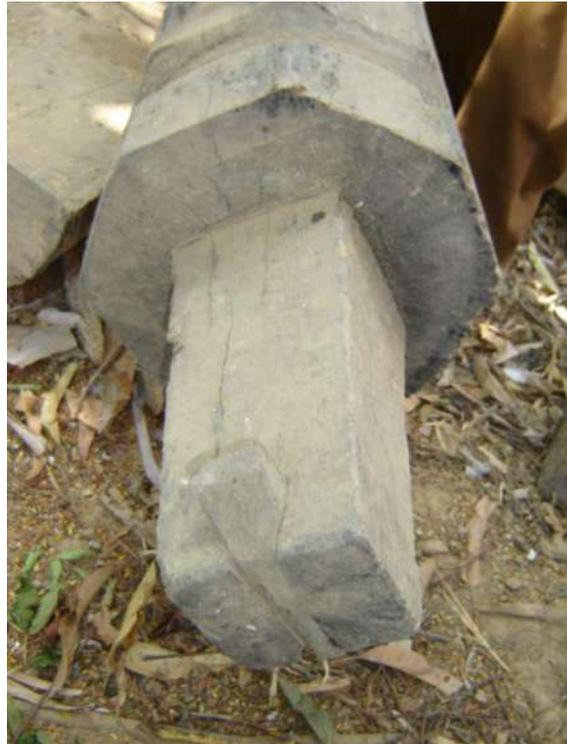
Figura 6. Eixo do carro de boi, terminando em *espiga* que é atravessada pela *cunha*.
