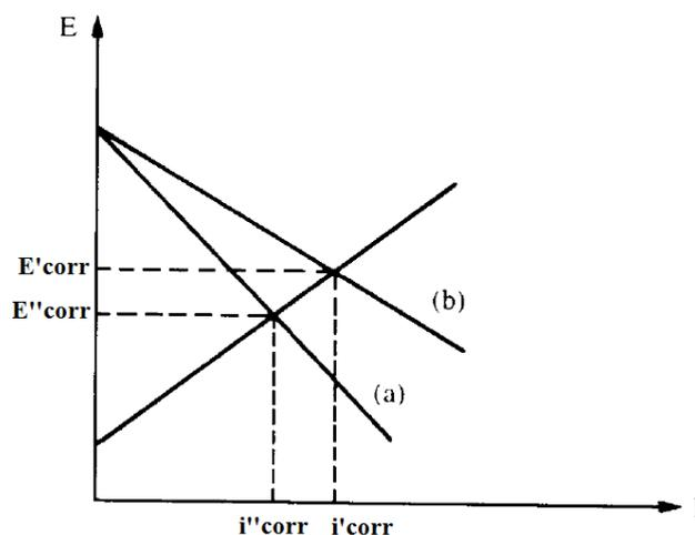
**Figura 14:** Diagrama de polarização da ação do inibidor catódico. (a) com inibidor e (b) sem inibidor.<sup>38</sup>
