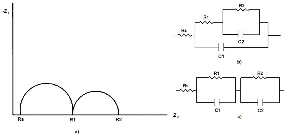
**Figura 20:** (a) Diagrama de Nyquist correspondente aos circuitos equivalentes (b) e (c) com duas constantes de tempo.<sup>41</sup>
