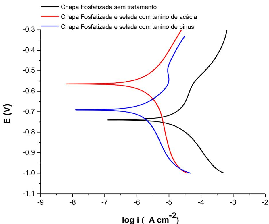
**Figura 46:** Curvas de polarização potenciodinâmica do aço carbono 1020 fosfatizado (com e sem a selagem com taninos) em  $\text{Na}_2\text{SO}_4$   $0,1 \text{ mol L}^{-1}$ , aerado, estático,  $\text{pH} = 6,0$  e à temperatura ambiente em 1 hora de imersão. Velocidade de varredura de  $5 \text{ mV/s}$  entre  $-1,0$  e  $-0,3 \text{ V}$ .
