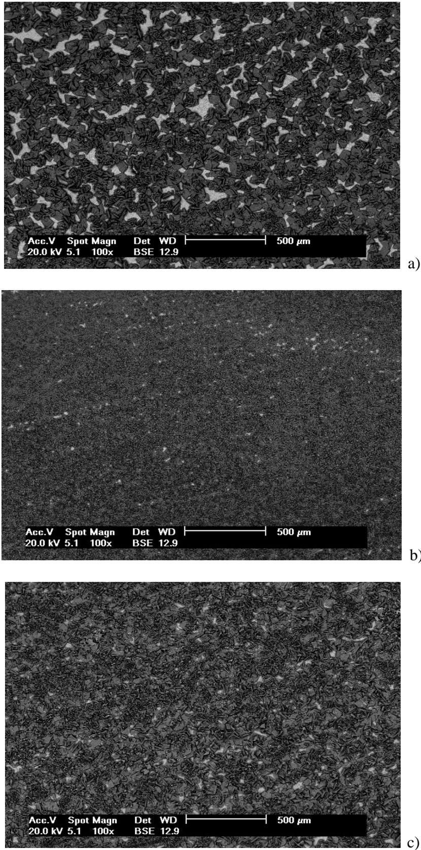
**Figura 39:** Micrografia no modo BSE com aumento de 100 vezes para a) chapa fosfatizada convencionalmente, b) chapa fosfatizada com a adição de tanino de acácia e c) fosfatizada com a adição de tanino de pinheiro.
