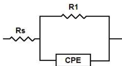
**Figura 49:** Circuito equivalente para o ajuste dos dados experimentais do aço fosfatizado não selado e selado com tanino de acácia e pinheiro imersos em  $\text{Na}_2\text{SO}_4$   $0,1 \text{ mol L}^{-1}$ .
