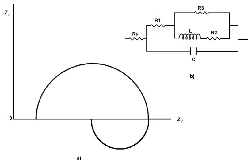
**Figura 21:** (a) Diagrama de Nyquist correspondente ao circuito equivalente (b) com um indutor.<sup>41</sup>
