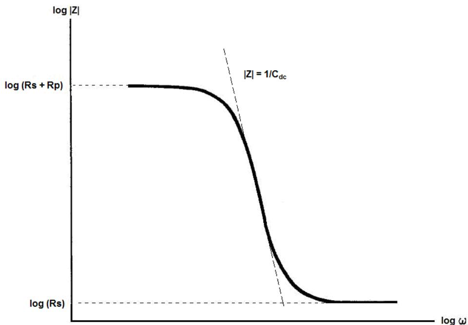
**Figura 18:** Obtenção dos valores das resistências de polarização e solução através do diagrama de Bode.<sup>41</sup>
