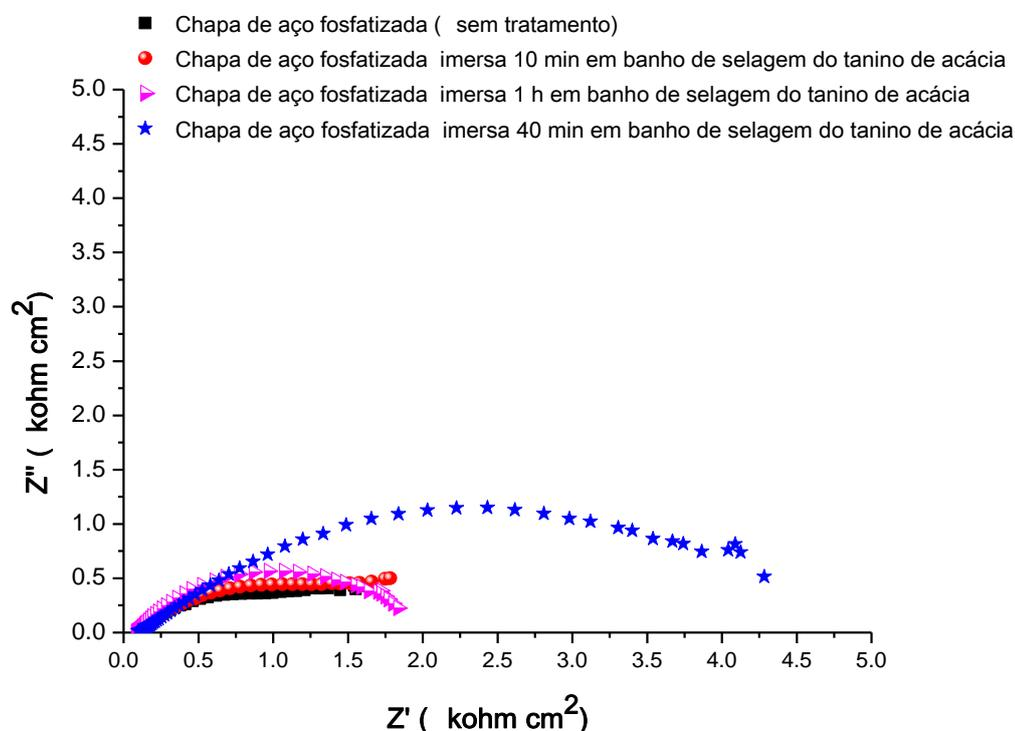
**Figura 45:** Diagrama de Nyquist para diferentes tempos de imersão das amostras de aço carbono 1020 fosfatizadas no banho de selagem com tanino de acácia. As curvas foram obtidas em solução Na<sub>2</sub>SO<sub>4</sub> 0,1 mol L<sup>-1</sup>, aerada, estática, pH=6,0 e à temperatura ambiente.
