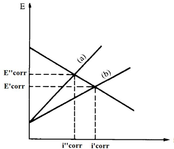
**Figura 13:** Diagrama de polarização da ação do inibidor anódico. (a) com inibidor e (b) sem inibidor.<sup>38</sup>
