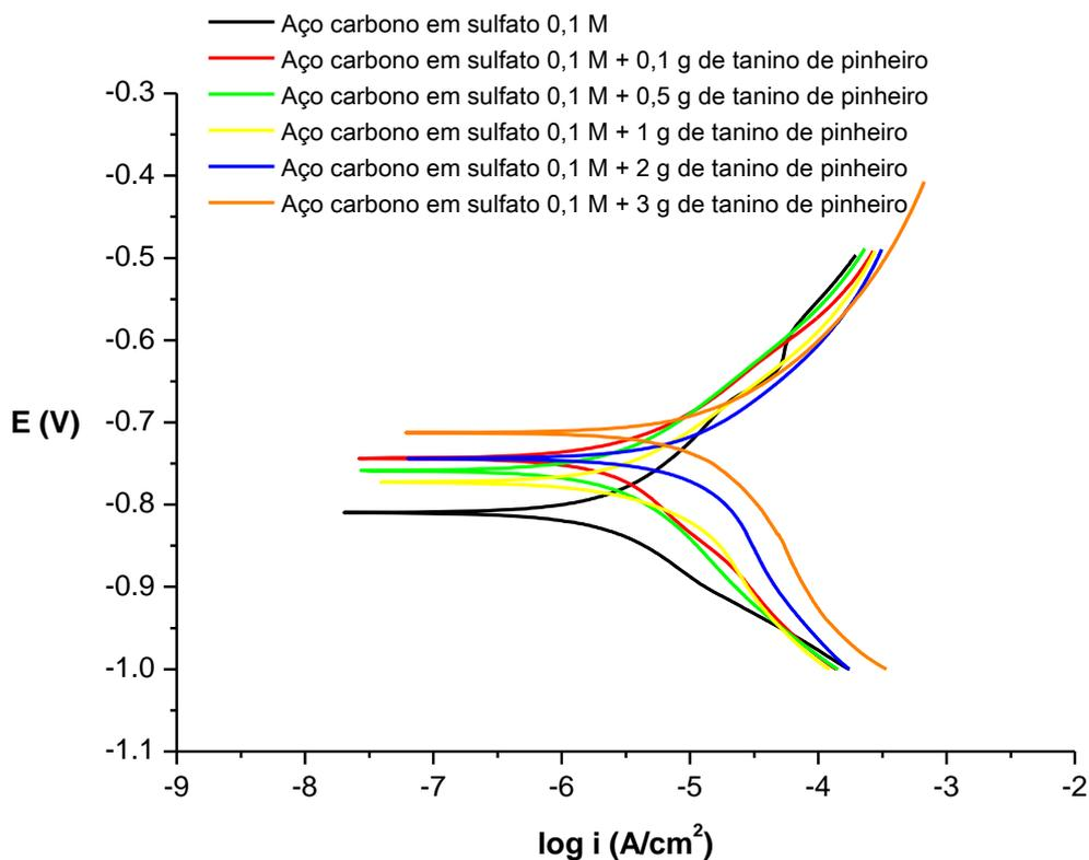
**Figura 27:** Curvas de polarização potenciodinâmica do aço carbono 1020 em meio  $\text{Na}_2\text{SO}_4$   $0,1 \text{ mol L}^{-1}$ , aerado, estático,  $\text{pH} = 6,0$  e à temperatura ambiente para diferentes concentrações de tanino de pinus em 1 hora de imersão. Velocidade de varredura de  $5 \text{ mV/s}$  entre  $-1,0$  e  $-0,3 \text{ V}$ .
