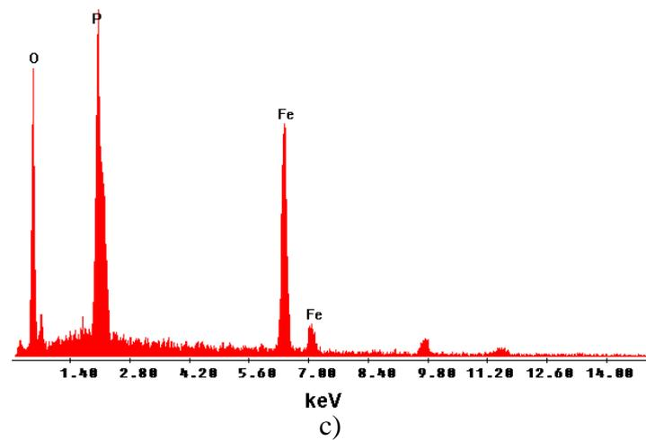
**Figura 43:** a) Micrografia no modo BSE com aumento de 1600 vezes para chapa fosfatizada com a adição de tanino de pinheiro. b) Espectro EDS para o ponto 1. c) Espectro EDS para o ponto 2.
