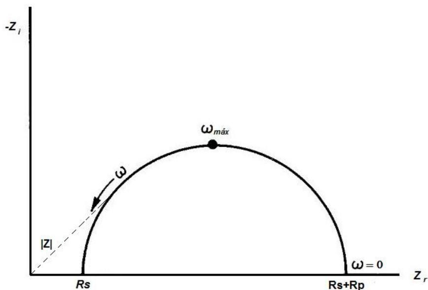
**Figura 17:** Obtenção dos valores das resistências de polarização e solução através do diagrama de Nyquist.<sup>41</sup>
