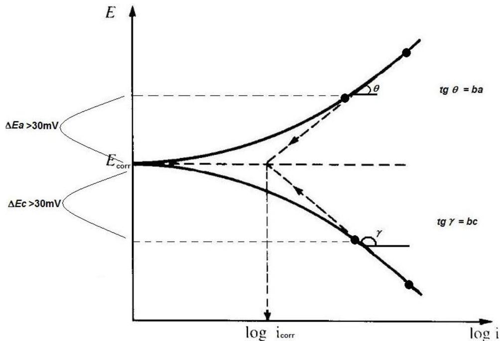
**Figura 15:** Representação da curva de polarização potenciodinâmica com as inclinações anódicas e catódicas de Tafel.
