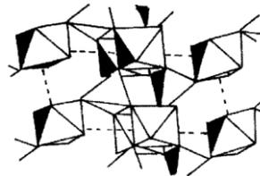
**Figura 23:** Estrutura cristalina de uma camada fosfatizada.<sup>45</sup>
