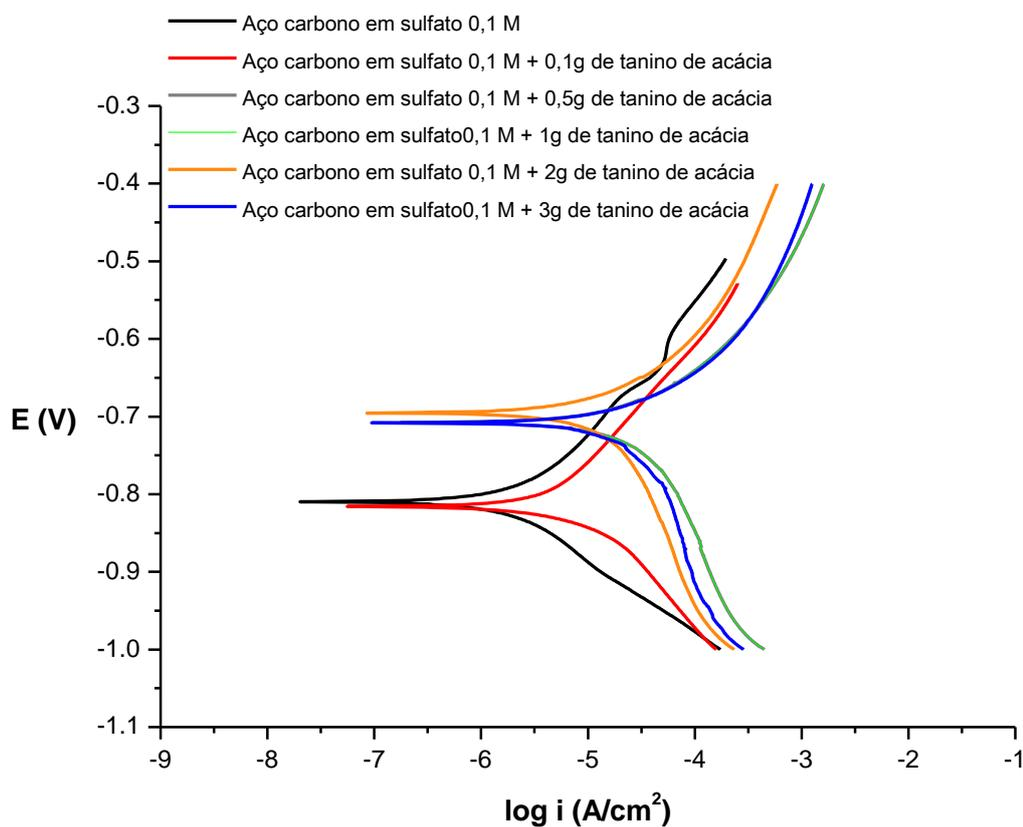
**Figura 26:** Curvas de polarização potenciodinâmica do aço carbono 1020 em meio  $\text{Na}_2\text{SO}_4$   $0,1 \text{ mol L}^{-1}$ , aerado, estático, pH = 6,0 e à temperatura ambiente para diferentes concentrações de tanino de acácia em 1 hora de imersão. Velocidade de varredura de  $5 \text{ mV/s}$  entre  $-1,0$  e  $-0,3 \text{ V}$ .
