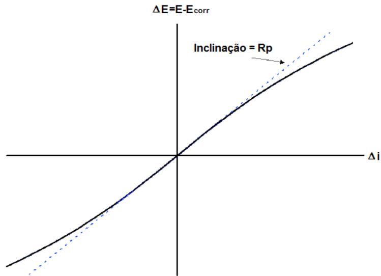
**Figura 16:** Curva de polarização  $\Delta E$  x  $\Delta i$  mostrando a inclinação correspondente ao valor da resistência de polarização. <sup>41</sup>
