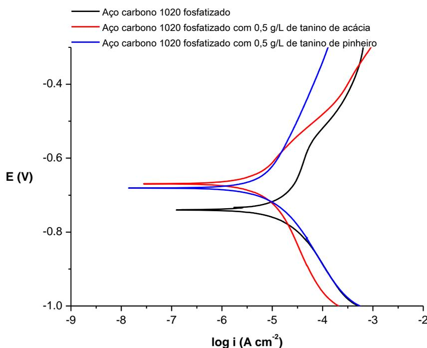
**Figura 37:** Curvas de polarização potenciodinâmica do aço carbono 1020 fosfatizado (a partir de banhos com e sem a incorporação de taninos) em  $\text{Na}_2\text{SO}_4$   $0,1 \text{ mol L}^{-1}$ , aerado, estático,  $\text{pH} = 6,0$  e à temperatura ambiente em 1 hora de imersão. Velocidade de varredura de  $5 \text{ mV/s}$  entre  $-1,0$  e  $-0,3 \text{ V}$ .
