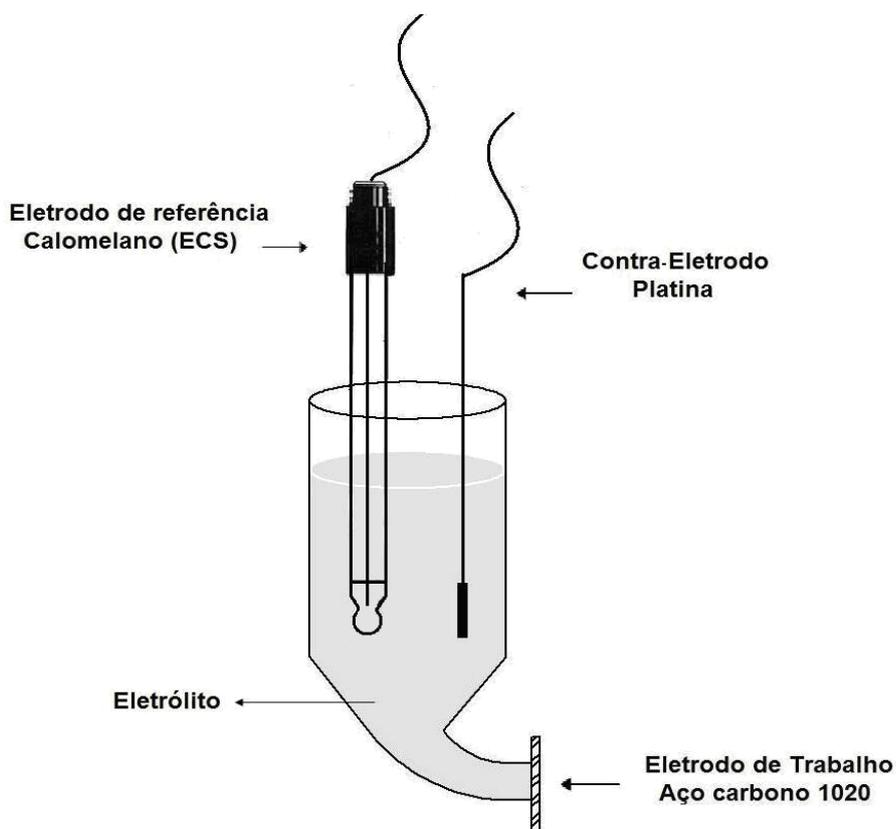
**Figura 25:** Esquema de montagem da célula de vidro com os respectivos eletrodos.
