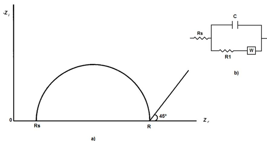
**Figura 22:** (a) Diagrama de Nyquist correspondente ao circuito equivalente (b) com uma impedância difusional Warbug.<sup>41</sup>
