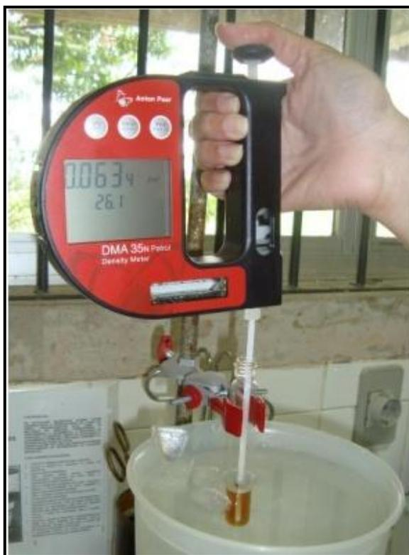
**Figura 8** – Sistema para determinação da massa específica.
