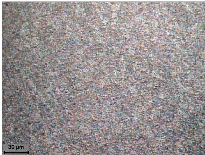
Figura 34 - Microscopia Óptica (MO): microestrutura na condição WQ800. Aumento 500X. Ataque – solução de metabissulfito (7% - 20s).
