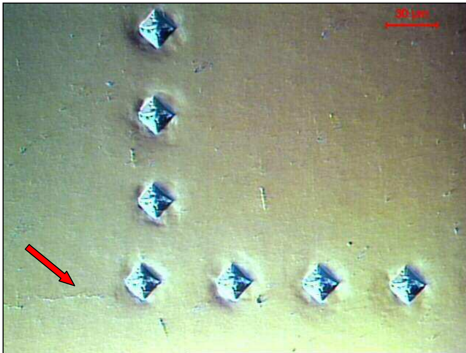
Figura 28 - Imagem das impressões de dureza Vickers em uma amostra na condição CR, realizada no microscópio óptico com um aumento de 500X. A seta indica a trinca de Fadiga.
