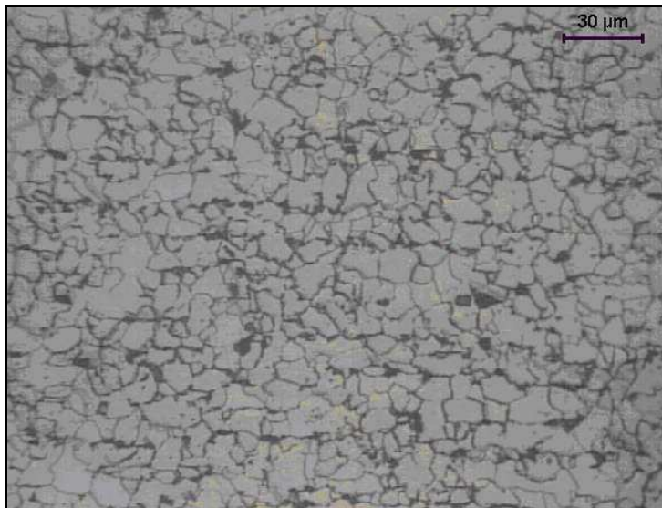
Figura 36 - Microscopia Óptica (MO): microestrutura na condição IT800-500. Aumento 500X. Ataque – nital (3% - 12s).
