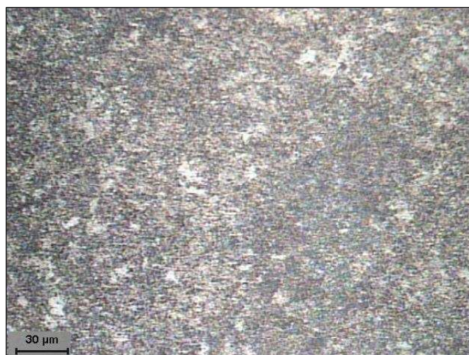
Figura 39 - Microscopia Óptica (MO): microestrutura na condição WQ950. Destacando a austenita retida (branca) presente no aço. Aumento 500X. Ataque – solução de metabissulfato de sódio (7% - 7s) e nital (3% - 7s).
