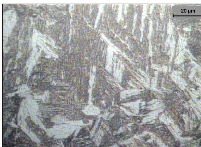
Figura 42 - Microscopia Óptica (MO): microestrutura na condição WQ1200. Evidenciando a formação de ripas devido ao forte aspecto cisalhante devido ao severo resfriamento imposto no tratamento. Aumento 1000X. Ataque – nital (3% - 5s) e solução de metabissulfito (7% -24s).
