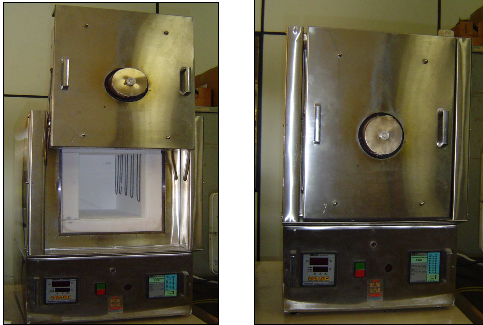
Figura 24 - Fotografia do forno da marca INTI-MAITEC, utilizado para aquecimentos dos CDP(s) do ensaio de propagação de trinca por fadiga.
