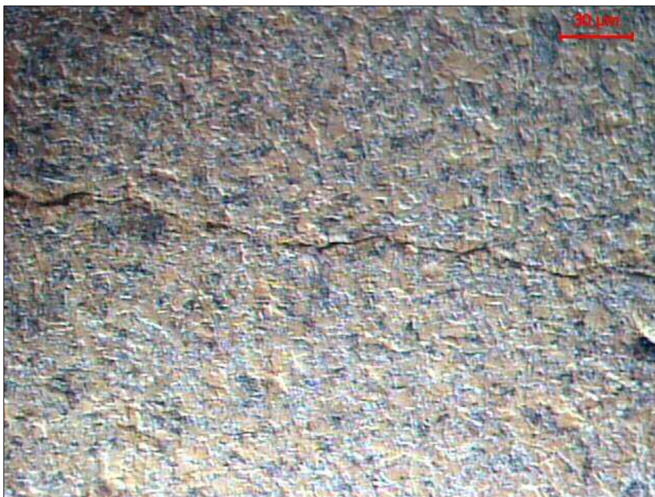
Figura 69 - Micrografia Óptica (MO) do caminho da trinca para condição WQ950. Ataque solução de nital (3% - 5s). Aumento original 500x.
