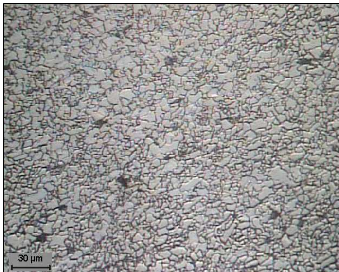
Figura 32 - Microscopia Óptica (MO): microestrutura do aço CR. Aumento 500X. Ataque – nital (3% - 4s) e solução de metabissulfito (7% - 5s).
