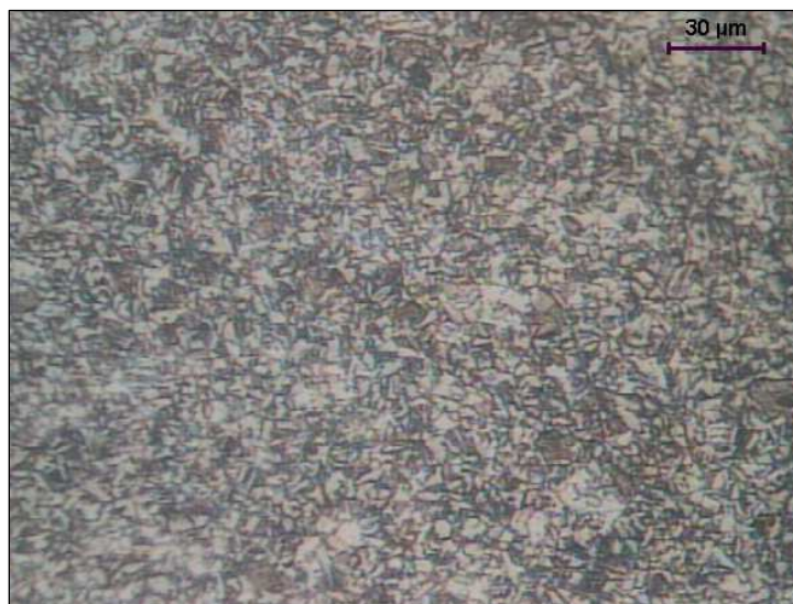
Figura 38 - Microscopia Óptica (MO): microestrutura na condição WQ950. Grãos escuros – martensita/bainita e grãos claros (ferrita/austenita retida). Aumento 500X. Ataque nital (3% - 15s).
