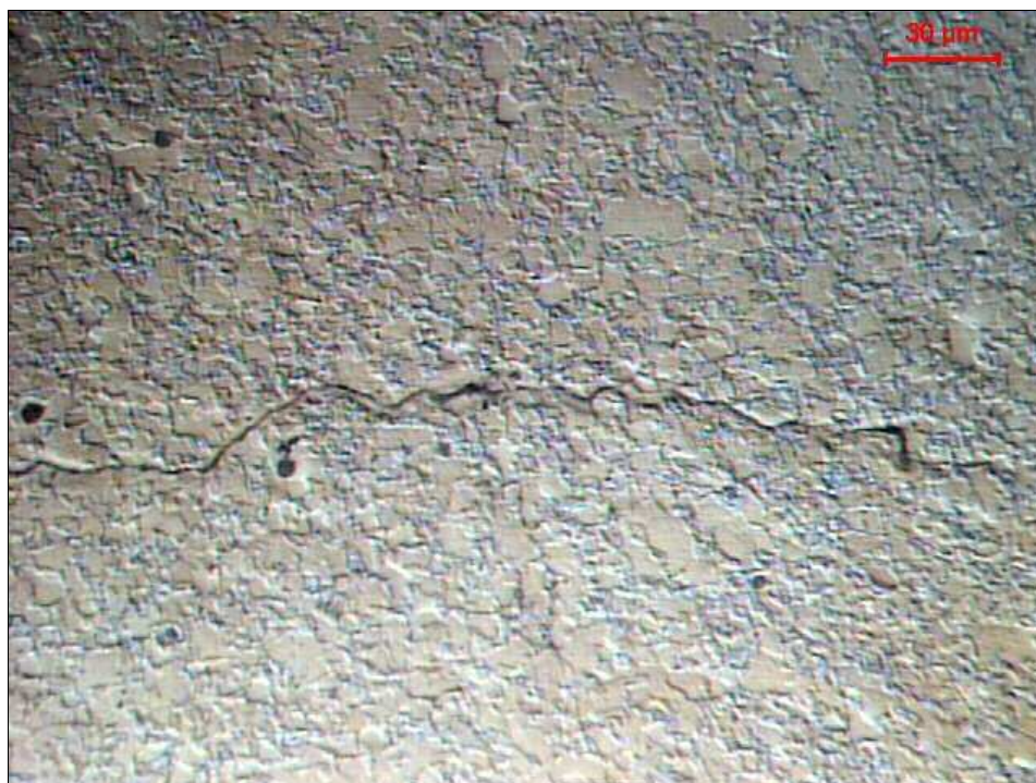
Figura 67 - Micrografia Óptica (MO) do caminho da trinca para condição WQ800. Ataque solução de nital (3% - 4s). Aumento original 500x.
