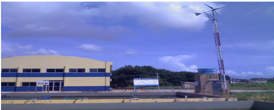
Figura 22 - Aplicação do aerogerador ENERSUD GERA246 de 1 kW de potência em pesquisa de desempenho em bombeamento d'água e armazenamento de energia potencial hidráulica do Laboratório de Energias Alternativas da UFC.
