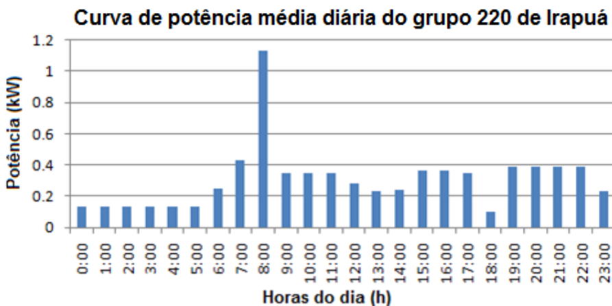
Figura 41 - Curva de potência típica média do grupo G220 obtida na pesquisa de junto à comunidade rural de Irapuá de Pentecoste-CE, em 15/02/2010.
