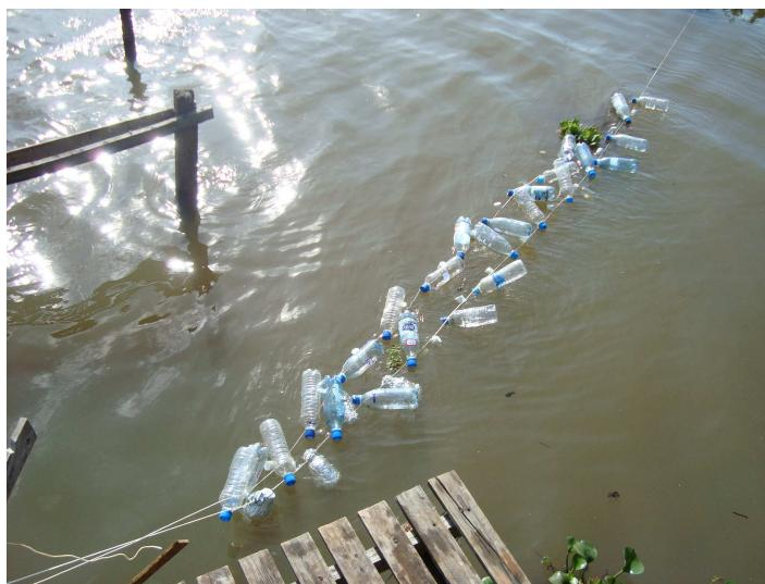
**Figura 6.** Foto das garrafas PET empregadas para manter as amostras utilizadas no experimento em microcosmo submersas no Rio Preto, para estudo do efeito da radiação solar na capacidade de complexação dos metais alumínio, cromo (VI) e níquel.
