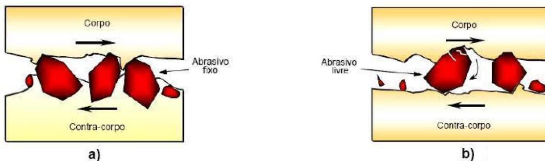
Figura 2.1 – Representação esquemática: a) desgaste abrasivo por deslizamento de partículas e b) desgaste abrasivo por rolamento de partículas.
