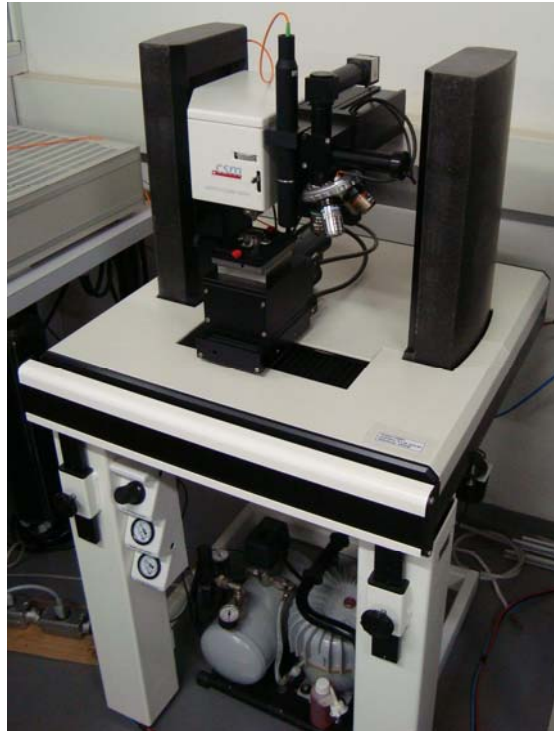
Figura 3.5 – Detalhe da plataforma de teste do equipamento CSM Micro-Combi Tester .
