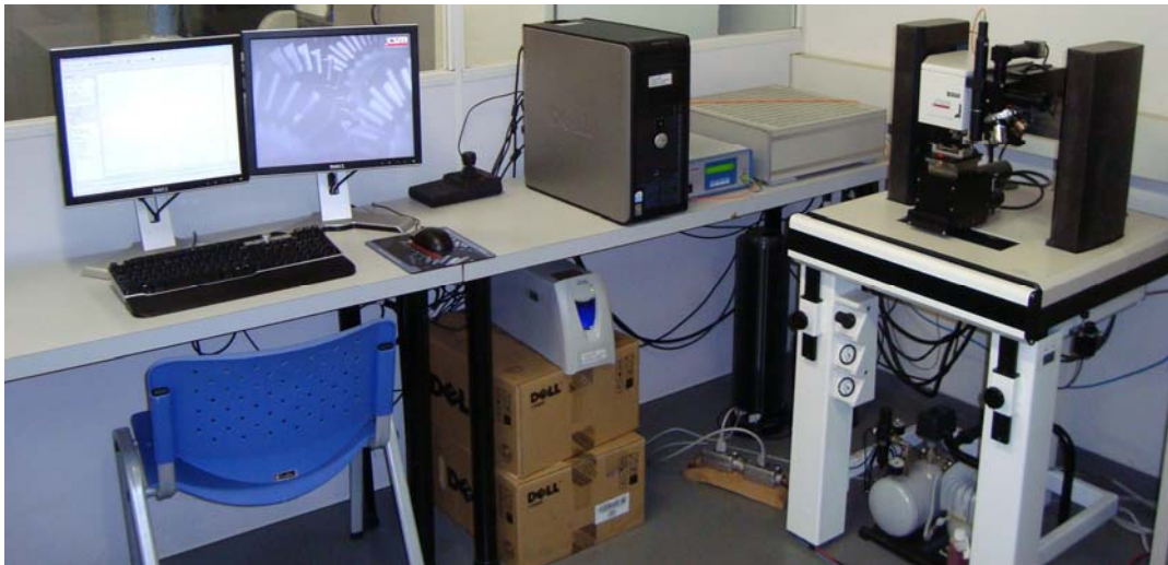
Figura 3.4 – Vista geral do equipamento de microesclerometria e microindentação CSM Micro-Combi Tester .
