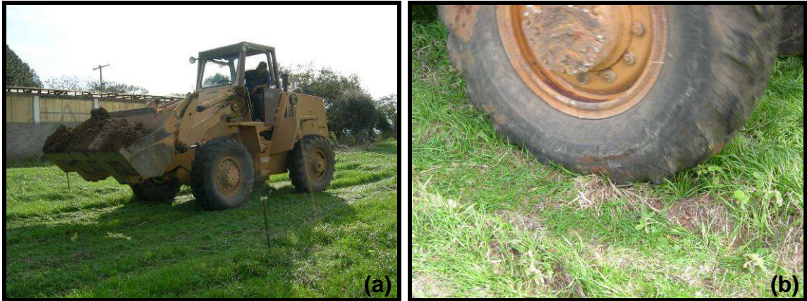
FIGURA 14 – Compactação do Argissolo Vermelho-Amarelo efetuada pelo tráfego da pá carregadora (a). Pneu deformando o solo durante o tráfego da pá carregadora (b).
