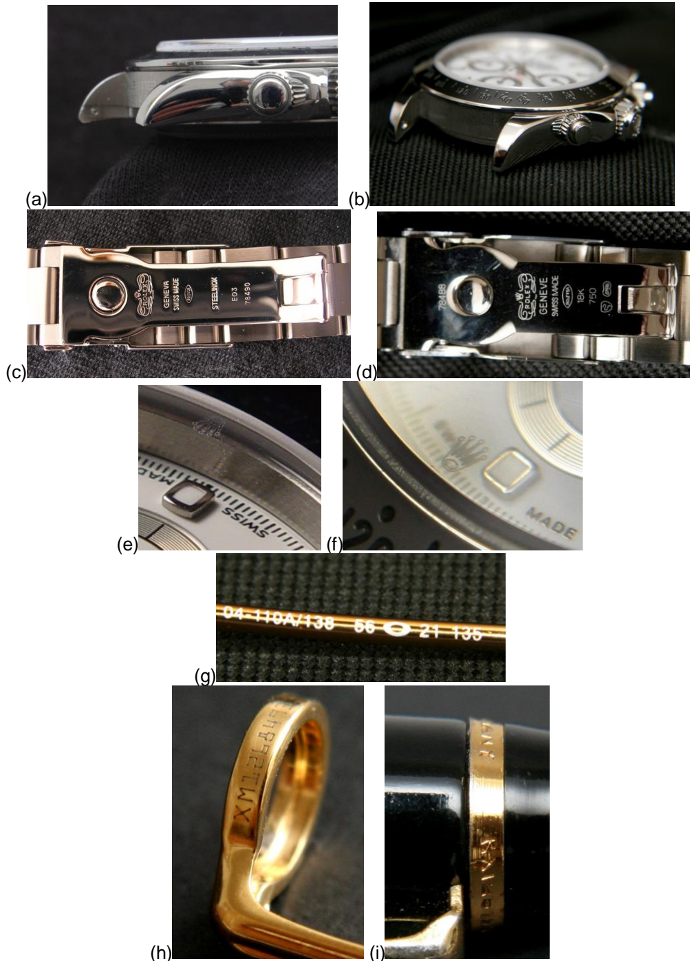
Figura 3.9 – Detalhes dos produtos estudados - (a) caixa do relógio original com identificação; (b) caixa do relógio falsificado sem identificação; (c) fecho da pulseira original; (d) fecho da pulseira falsificada; (e) gravação na safira do relógio original; (f) gravação na safira do relógio falsificado; (g) identificação na haste do óculos falsificado; (h) gravação no clip da caneta original; (i) gravação no clip da caneta falsificada. Fonte: fotos do autor desta dissertação
