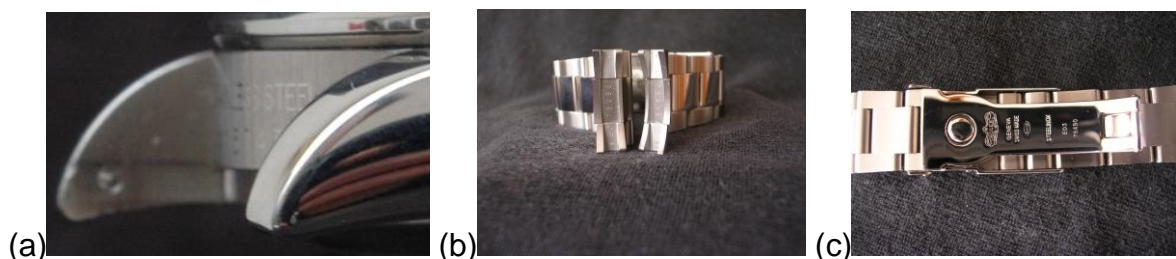
Figura 3.18 – Identificação dos produtos: (a) número de identificação na caixa; (b) número de identificação no elo de ligação pulseira-caixa; (c) número de identificação na parte interna do fecho da pulseira.
