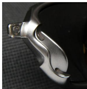
Figura 3.10 – Geometrias em aro de óculos falsificado
