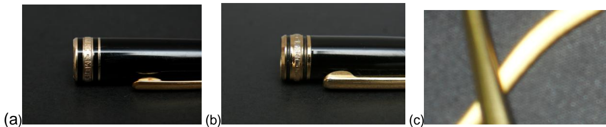
Figura 3.6: (a) caneta original: banho em ouro; (b) caneta falsificada: revestimento dourado; (c) hastes dos óculos falso e original: pintura dourada e revestimento metálico.
