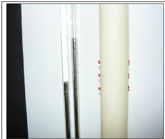
**Figura 36:** Foto de parte do aparato experimental dando enfoque ao manômetro de mercúrio (à esquerda) e o tubo de látex com os pontos de referência (à direita).
