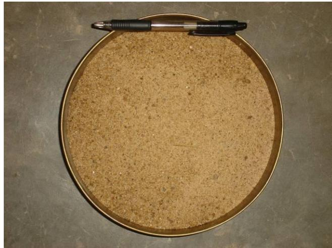
Figura 6 – Agregado miúdo natural.
