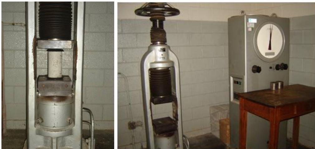
Figura 23 – Prensa para ensaios de compressão simples.
