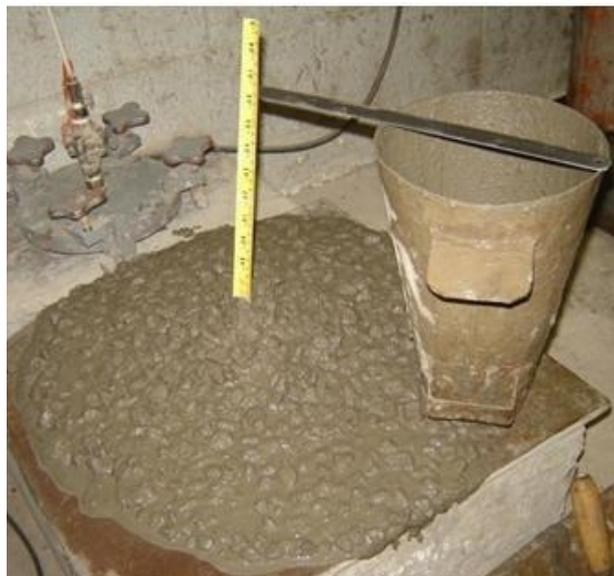
Figura 17 – Ensaio de abatimento (*Slump Test*).
