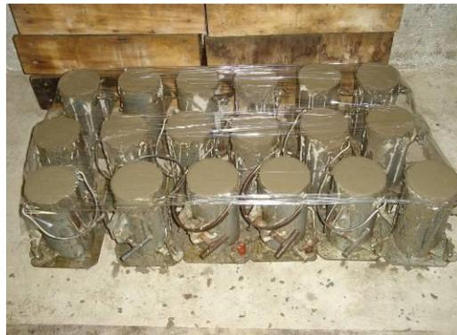
Figura 20 - Moldagem dos corpos-de-prova.
