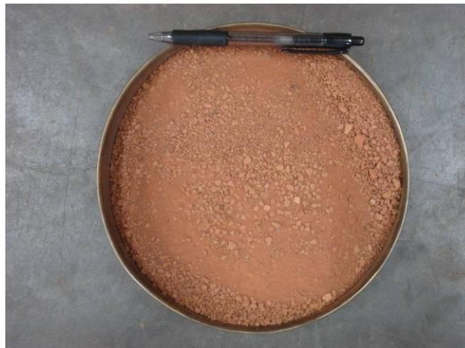
Figura 10 – Agregado miúdo artificial (cerâmica vermelha) triturado.
