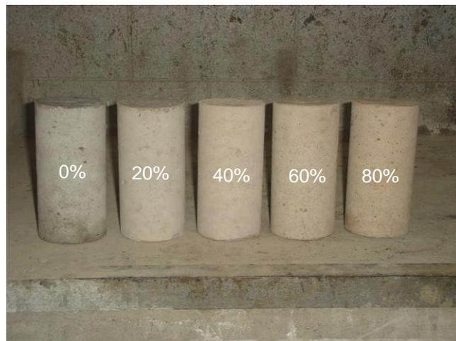
Figura 16 – Coloração dos corpos-de-prova com os diferentes teores de substituição.
