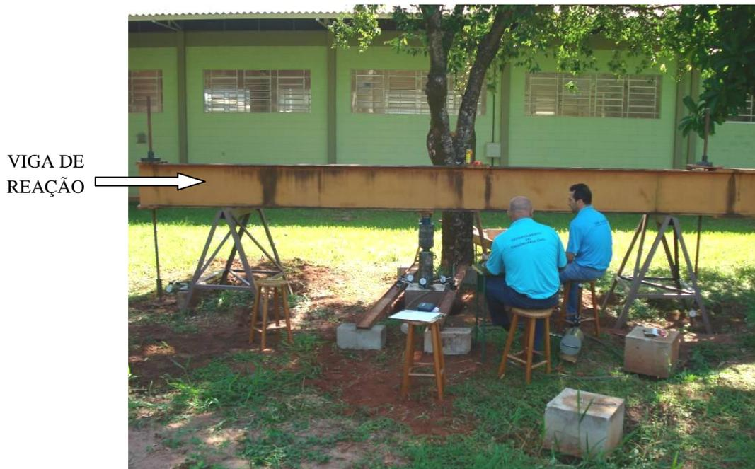
Figura 41 – Início do ensaio; equipamentos e viga de reação instalados para o ensaio.
