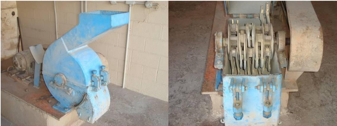
Figura 9 – Britador de facas do Laboratório CESP de Engenharia Civil.
