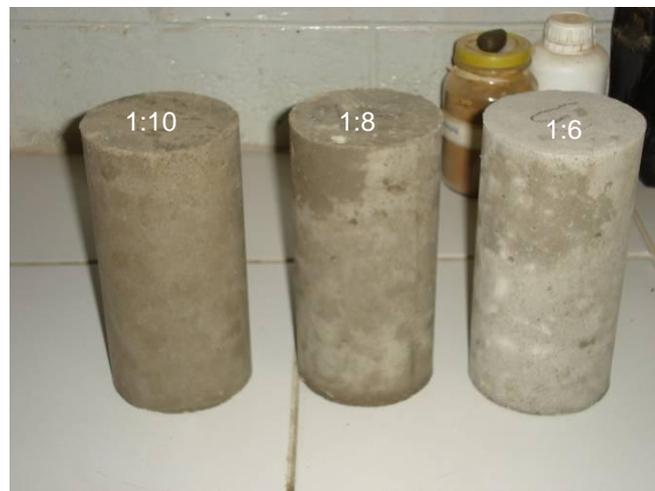
Figura 15 – Corpos-de-prova moldados para o estudo de dosagem - traços 1:10, 1:8 e 1:6.
