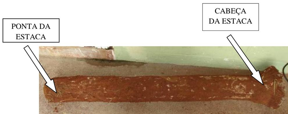
Figura 29 – Mini-estaca retirada do campo para ser ensaiada.
