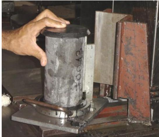
Figura 22 – Capeamento dos corpos-de-prova.
