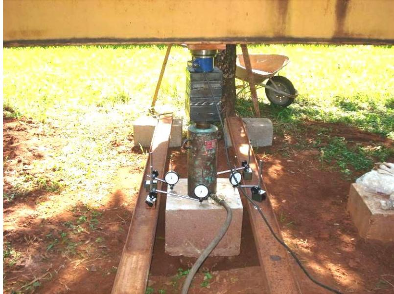
Figura 42 – Montagem da prova de carga.
