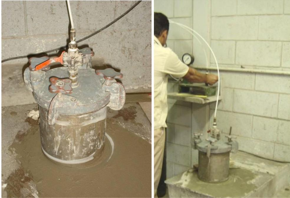
Figuras 18 – Aparelho (de pressão) que mede a quantidade de ar incorporado.
