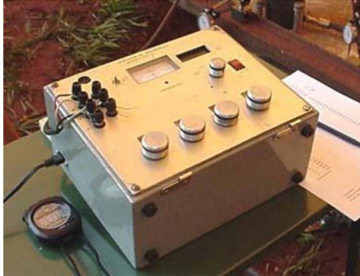
Figura 45 – Indicador de deformações.
