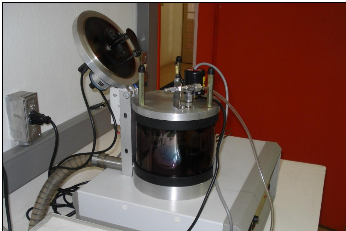
Figura 19 – Fotografia ilustrativa da Metalizadora EMITECH modelo K450, utilizada para metalizar os fragmentos de carvão, manuseio realizado no Departamento de Geologia e Recursos Naturais (DGRN) da UNICAMP/SP
