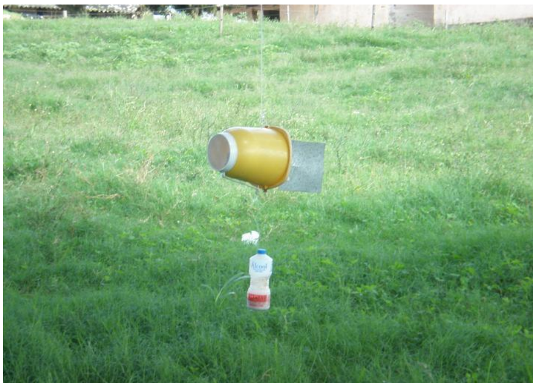
Figura 1 – Armadilha W.O.T. (Wind Oriented Trap – armadilha orientada pelo vento).
