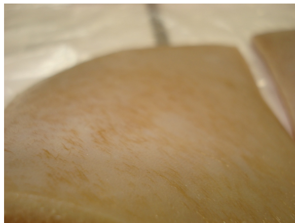
Figura 44: Imagem de uma pele ao final de um teste de caleiro coenzimático
