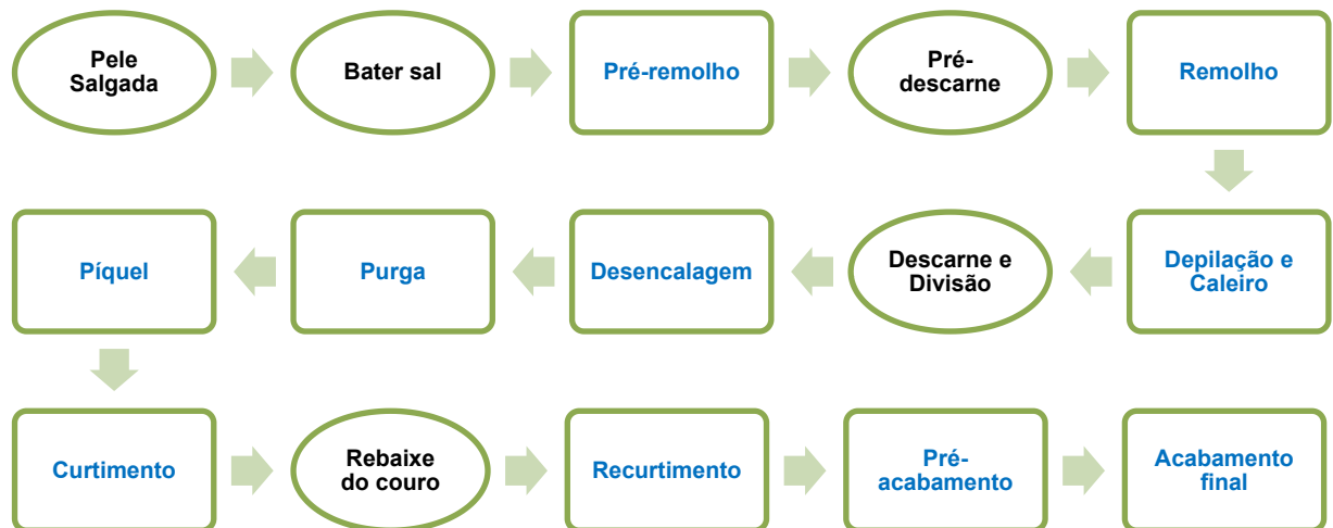
Figura 11: Fluxograma de processamento do couro (as etapas descritas em retângulos indicam que o processo ocorre em meio aquoso)
