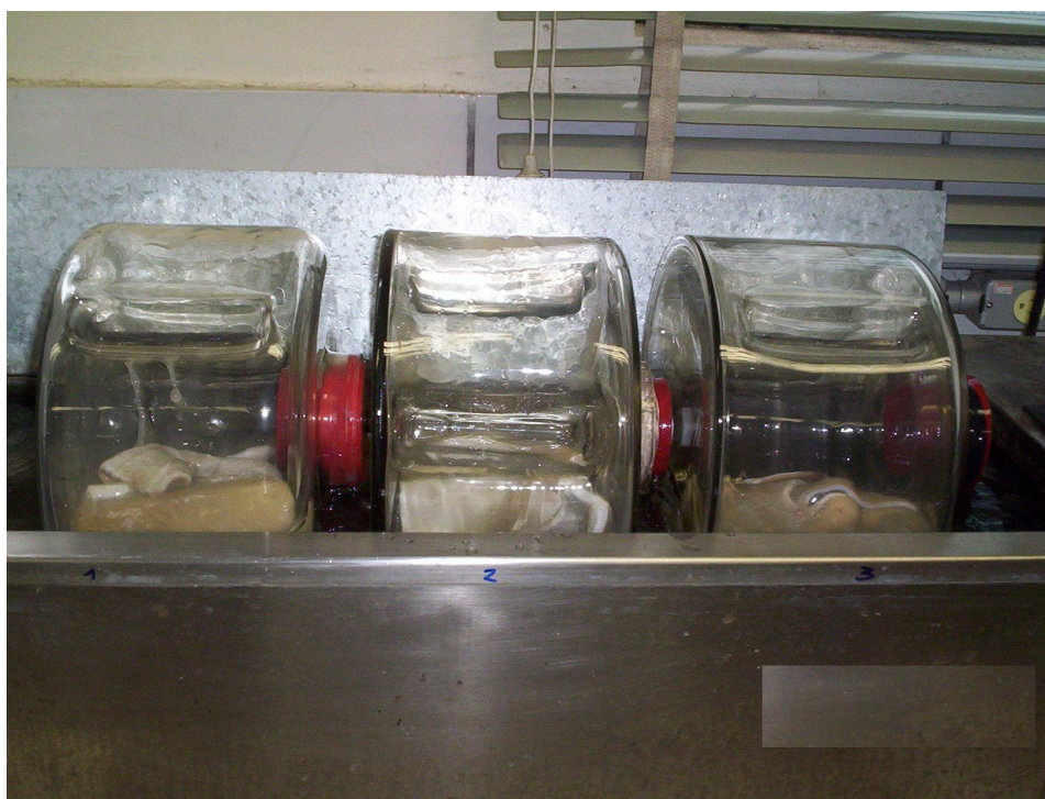
Figura 19: Fotografia dos fulões de bancada utilizados na realização dos experimentos
