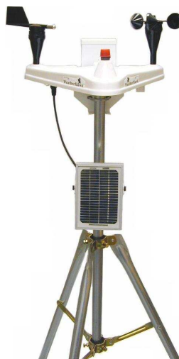
Fotografia 5 – Foto da estação meteorológica WeatherHawk Weather Station.
