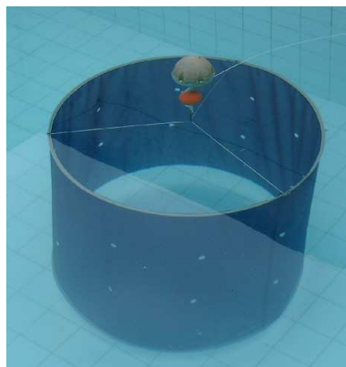
Fotografia 4 – Vela de arrasto montada e acoplada a parte emersa do derivador
