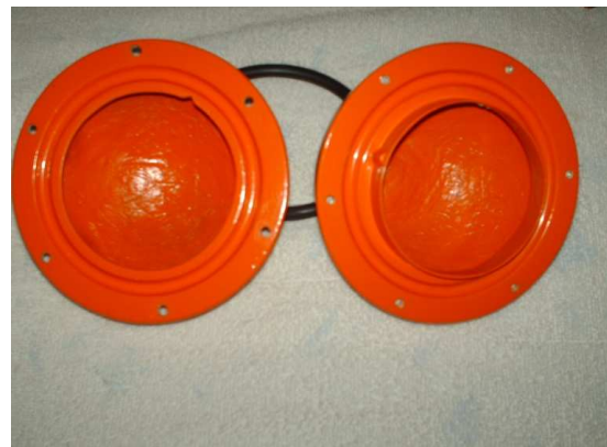
Fotografia 2 – Imagem da estrutura emersa evidenciando o espaço interno para a alocação das partes eletrônicas.
