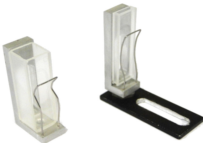
Figura 5.10 – Foto dos portas amostras para cubetas de 2mm e de 10mm, construídos especificamente para garantir a manipulação das amostras sem alterar suas características em nossas medidas.
