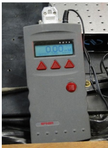
Figura 5.5 – Medidor de potência dos feixes de lasers com precisão de até 30 mW.
