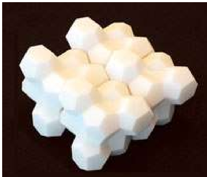
Figura 5.64 Modelagem das células para definição da forma estrutural do Cubo Aquático (Arup apud GONCHAR, 2008).
