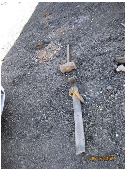
Figura 6.51 Vista da marreta de cravação de estaca em perfil dobrado e calandrado (da autora, 2009).
