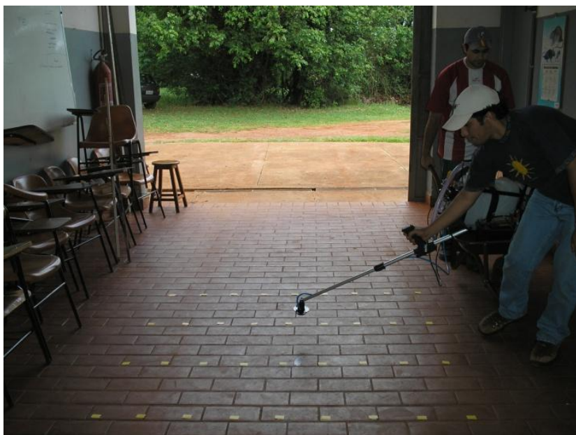
Figura 4. Detalhe da aplicação com bico rotativo para avaliação da distribuição volumétrica da calda.
