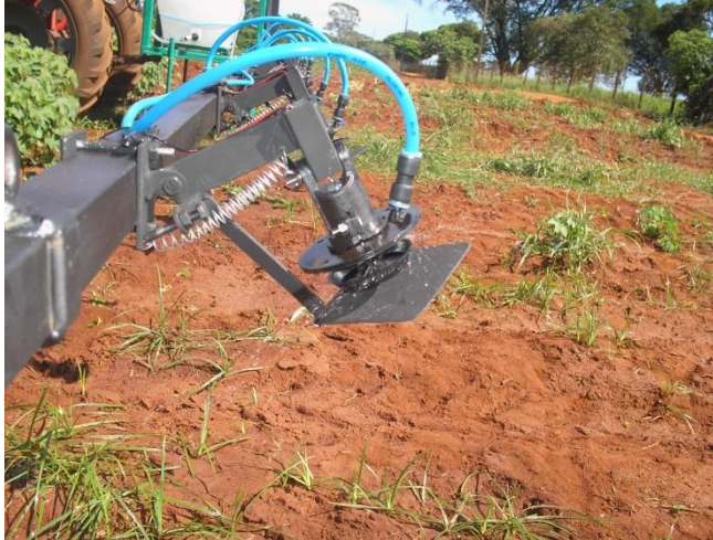
Figura 2. Bico rotativo Ecos da Apoiotec para avaliação de cobertura pelas gotas e deposição de inseticida na cultura do algodão.
