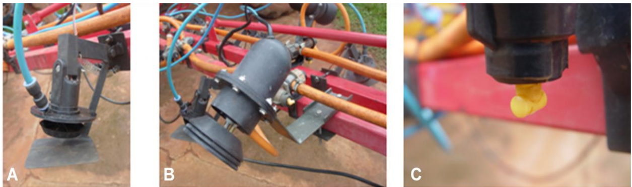
Figura 2. (A) Bico centrífugo Ecos; (B) Bico centrífugo Turbotrator; (C) Bico Hidráulico TT11002 utilizados para avaliação da cobertura, deposição, tamanho de gotas, controle do bicudo-do-algodoeiro e produtividade do algodão
