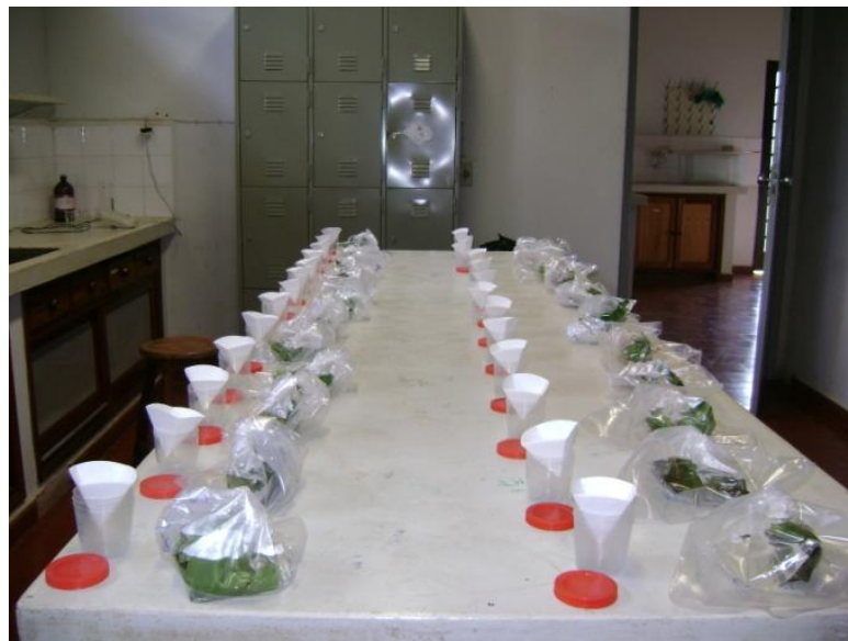
Figura 3. Processo de extração de HCl para determinação da deposição de gotas nas folhas de algodoeiro.
