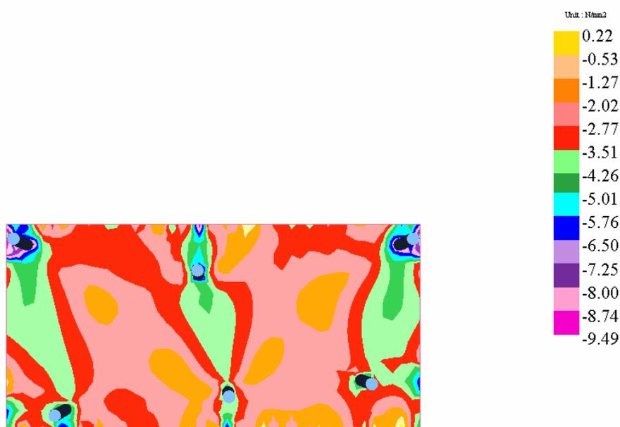
FIGURA 8.167 – Tensões Mínimas nas Fibras Inferiores em Condições de Serviço
