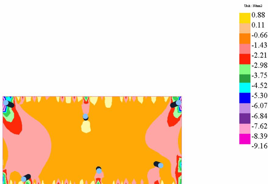
FIGURA 8.171 – Tensões no Plano Médio da Laje (Espessura/2) na Direção dos Cabos Distribuídos, em Condições de Serviço (N/mm<sup>2</sup>)
