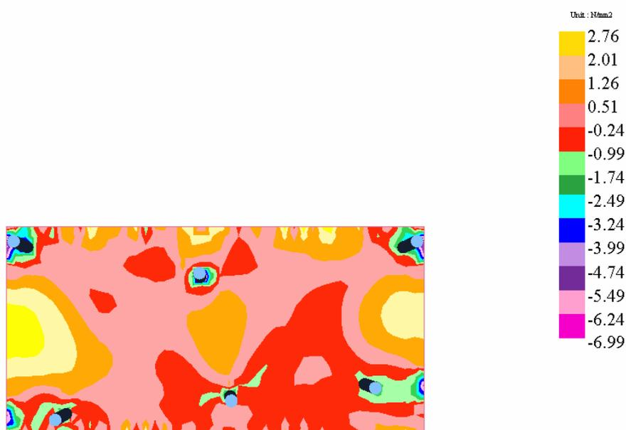
FIGURA 8.165 – Tensões Máximas nas Fibras Inferiores em Condições de Serviço
