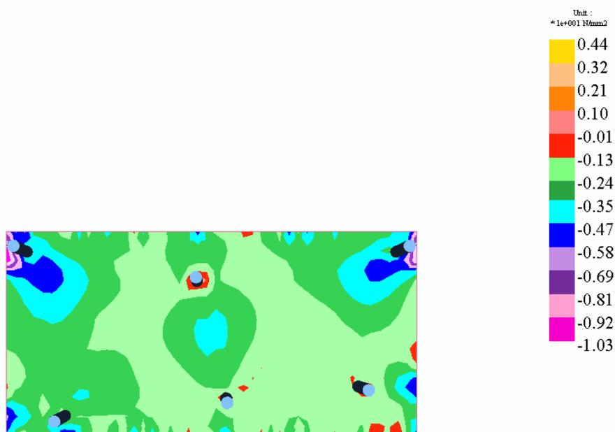
FIGURA 8.166 – Tensões Mínimas nas Fibras Superiores em Condições de Serviço
