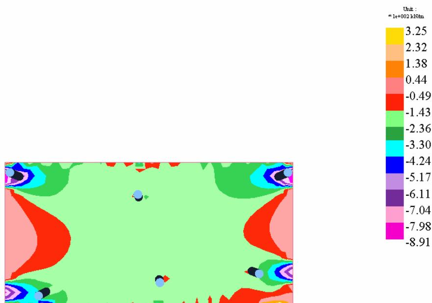
FIGURA 8.168 – Ações Axiais na Laje na Direção dos Cabos Concentrados, em Condições de Serviço, (100 x kN/m) (Observar as Zonas de Regularização de Tensões)
