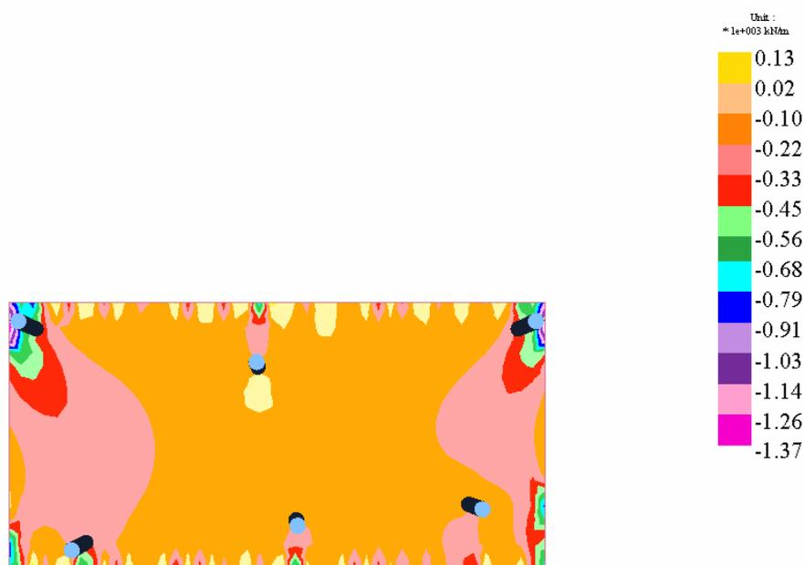
FIGURA 8.169 – Ações Axiais na Laje na Direção dos Cabos Distribuídos, em Condições de Serviço (1000 x kN/m)
