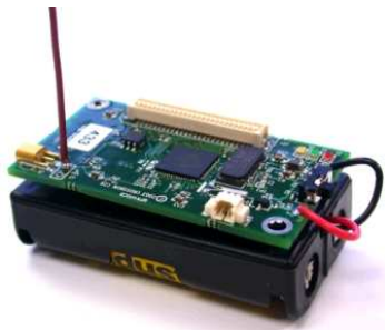
(a) Mica2 sensor node.
