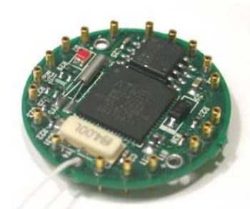
(b) Mica2Dot sensor node.
