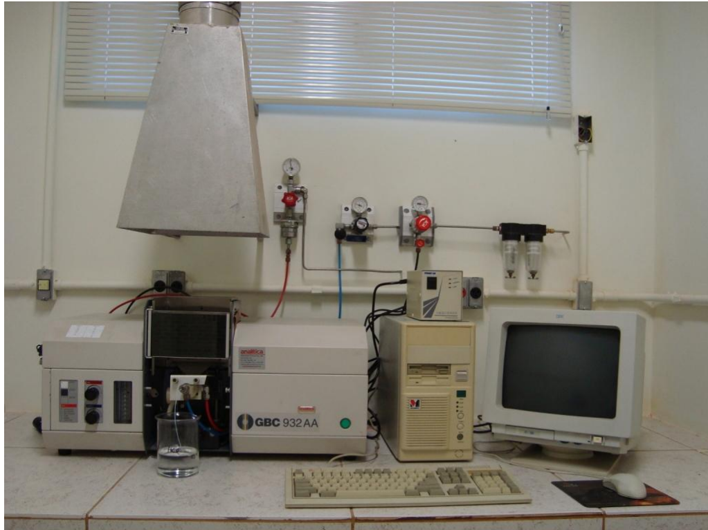
Figura 5. Espectrofotômetro de absorção atômica em chama utilizado para quantificação do cobre metálico do fungicida Supera.
