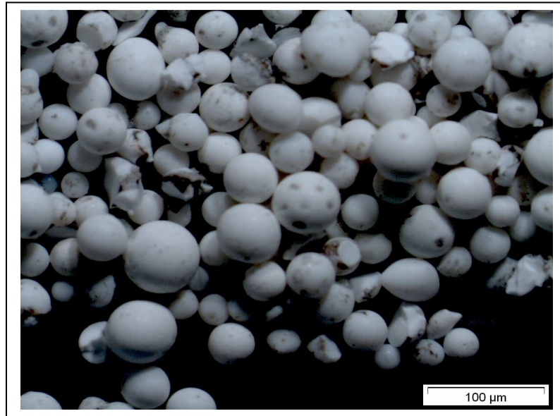
Figura 22 – Micrografia de microscopia ótica, aumento de 20x, do copolímero sintetizado com 2,5 % de ferro
