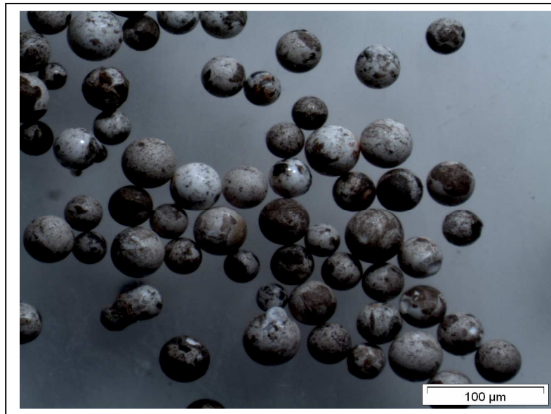
Figura 26 – Micrografia de microscopia ótica, aumento de 20x, do copolímero sintetizado com 15 % de ferro
