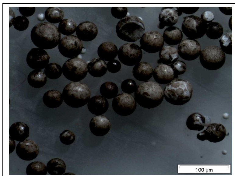
Figura 13 – Micrografia de microscopia ótica do copolímero R1, aumento de 20x, obtido adicionando a fase orgânica sobre a fase aquosa
