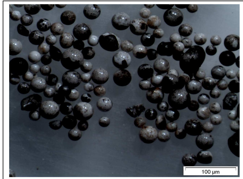
Figura 47 – Micrografia de microscopia ótica do copolímero sintetizado com gelatina - aumento de 20x
