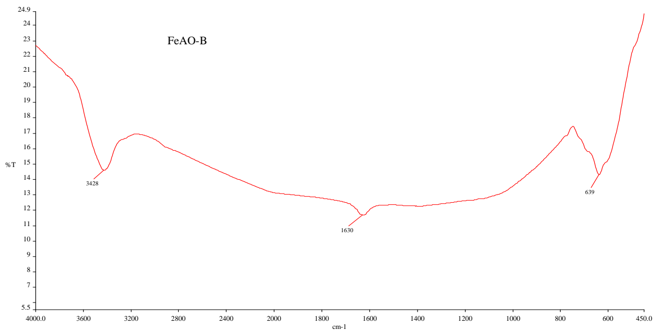
Figura 12 – Espectro de infravermelho do ferro tratado com ácido oleico
