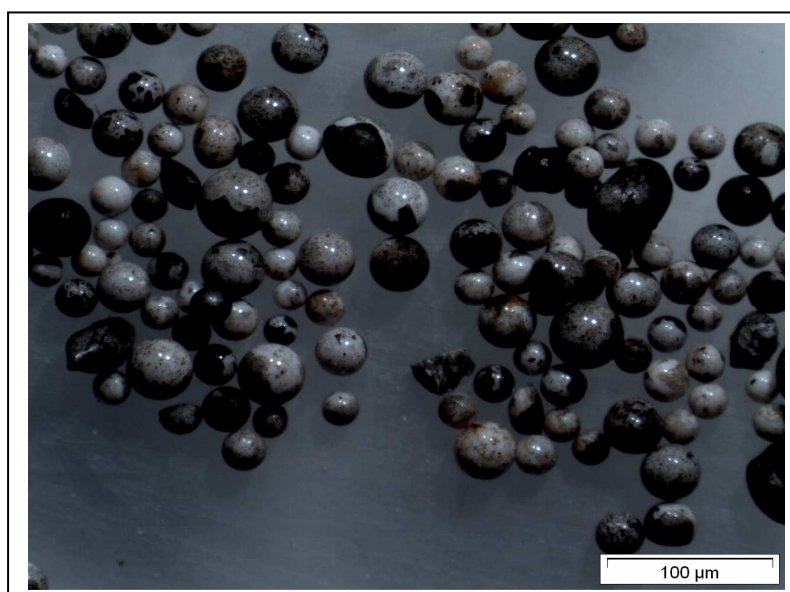
Figura 54 – Micrografia de microscopia ótica, aumento de 20x, do copolímero sintetizado com velocidade de agitação de 400 RPM.
