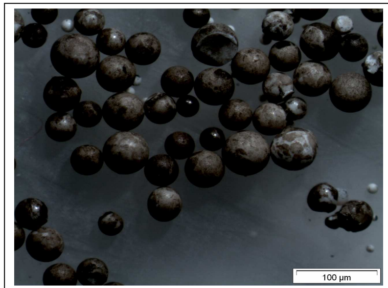
Figura 23 – Micrografia de microscopia ótica, aumento de 20x, do copolímero sintetizado com 5,0 % de ferro
