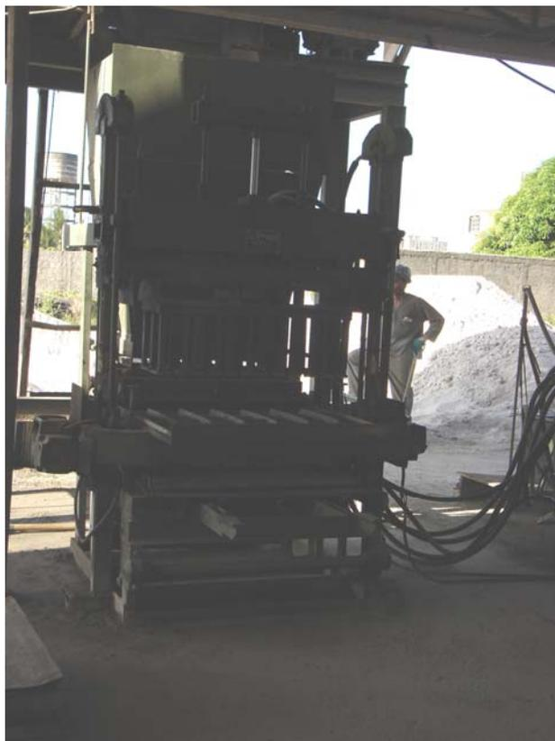
Figura 2.9 – Prensagem dos blocos
