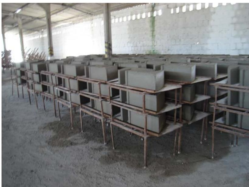
Figura 2.10 – Secagem e cura dos blocos
