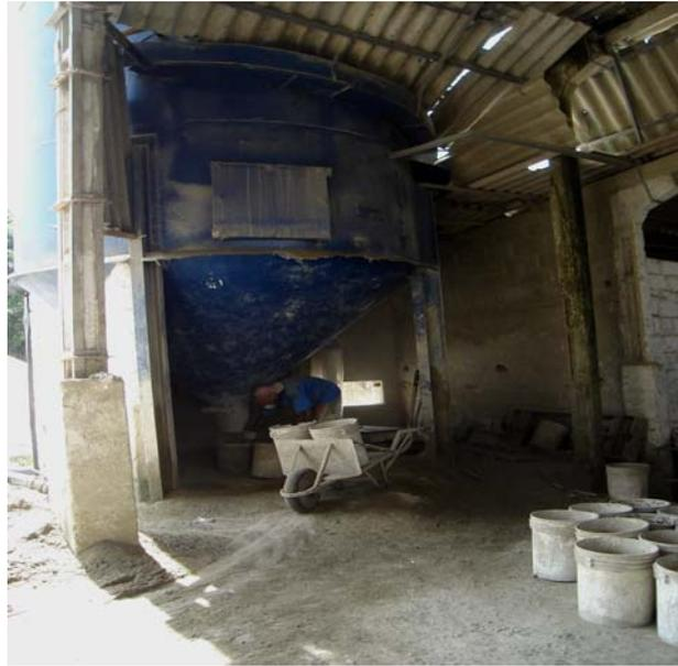
Figura 3.6 - Armazenamento da matéria prima cimento
