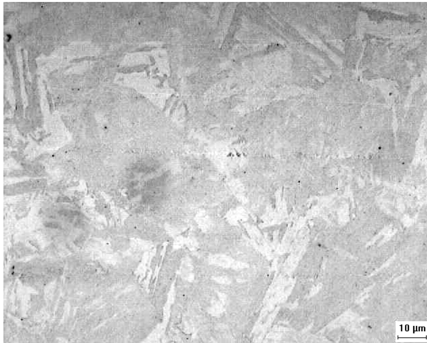
Figura 234 - Micrografia da amostra envelhecida a 600°C e resfriada em água.
