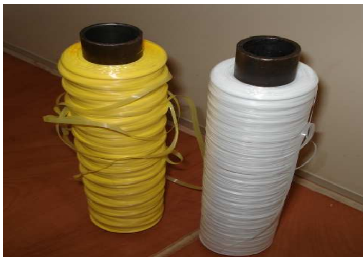
Figura 19: Bobinas de fita de trama e de urdume Fonte: REGISTRO FOTOGRÁFICO DO AUTOR, 2008.
