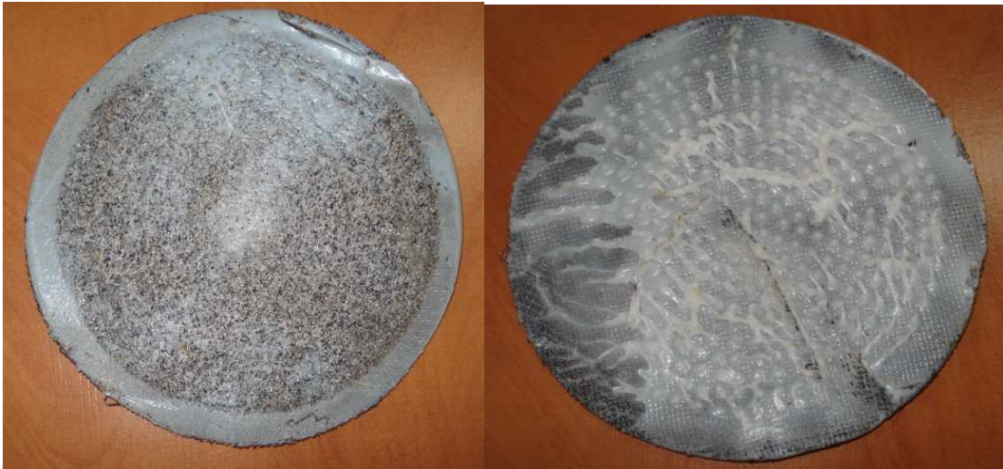
Figura 17: Entrada de massa no filtro Fonte: REGISTRO FOTOGRÁFICO DO AUTOR, 2008.
