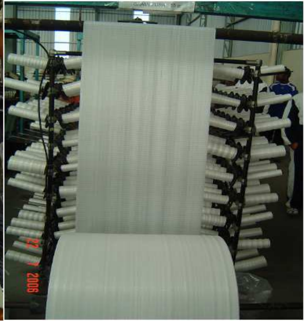
Figura 24: Bobinador de saída do tecido Fonte: REGISTRO FOTOGRÁFICO DO AUTOR, 2006.
