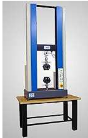
Figura 32: Máquina de ensaios de tração modelo Emic DL 10000 versão 3.05
