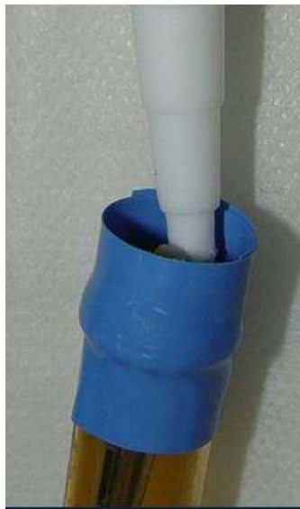
Figura 7 – Aplicação de adesivo silicone.
