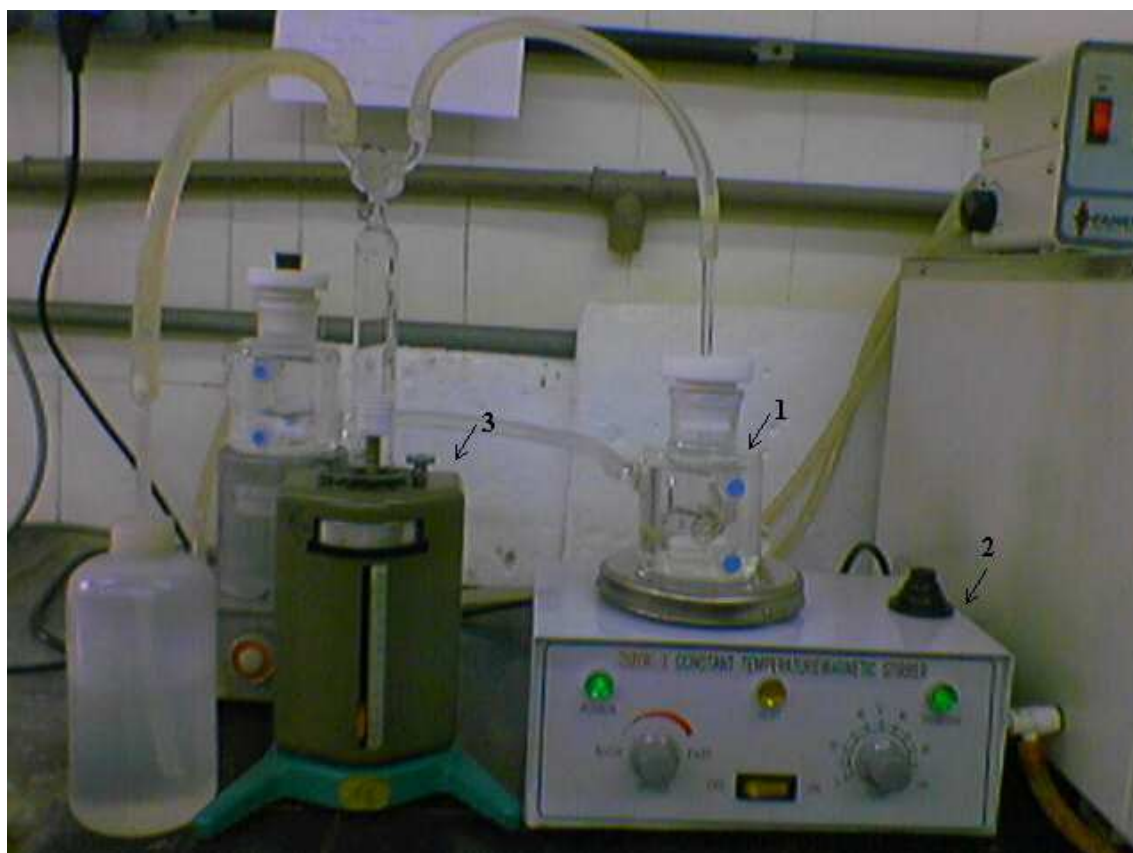
Figura 3.6 – Esquema de montagem dos equipamentos para o método da determinação do ponto de turbidez.
